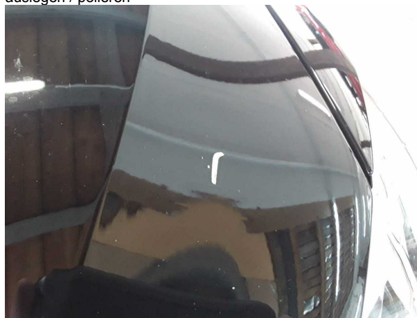
Beschädigung #1: Motorhaube: Motorhaube - Steinschlag - auslegen / polieren
