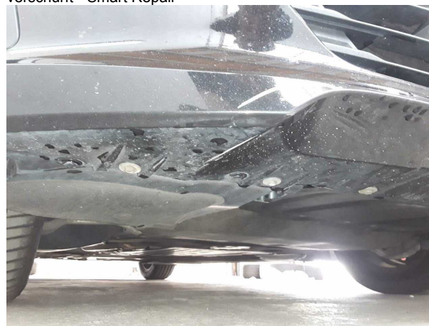
Beschädigung #4: Stossfänger vorn: Spoiler - verkratzt / verschürft - Smart Repair
