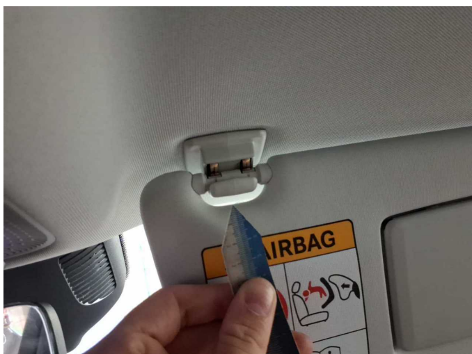
Damage 3: Interior: Sun visor - left side (Kontakt für licht ohne funktion) - Sub-function - Replace
