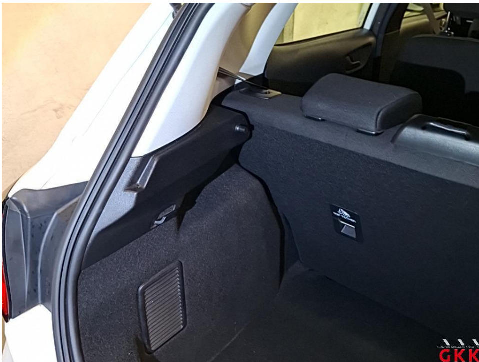
Bild 14 Laderaum, Abdeckung, fehlt, ersetzen
