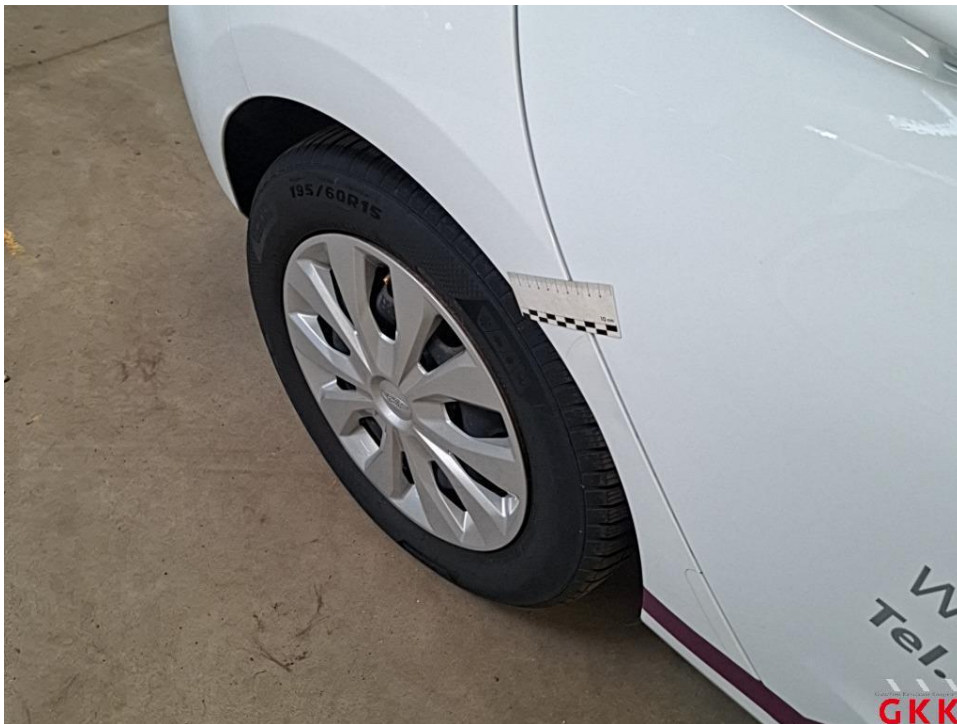
Bild 20 Seitenwand rechts, hinten -unterhalb-, beschädigt, instand setzen - lackieren
