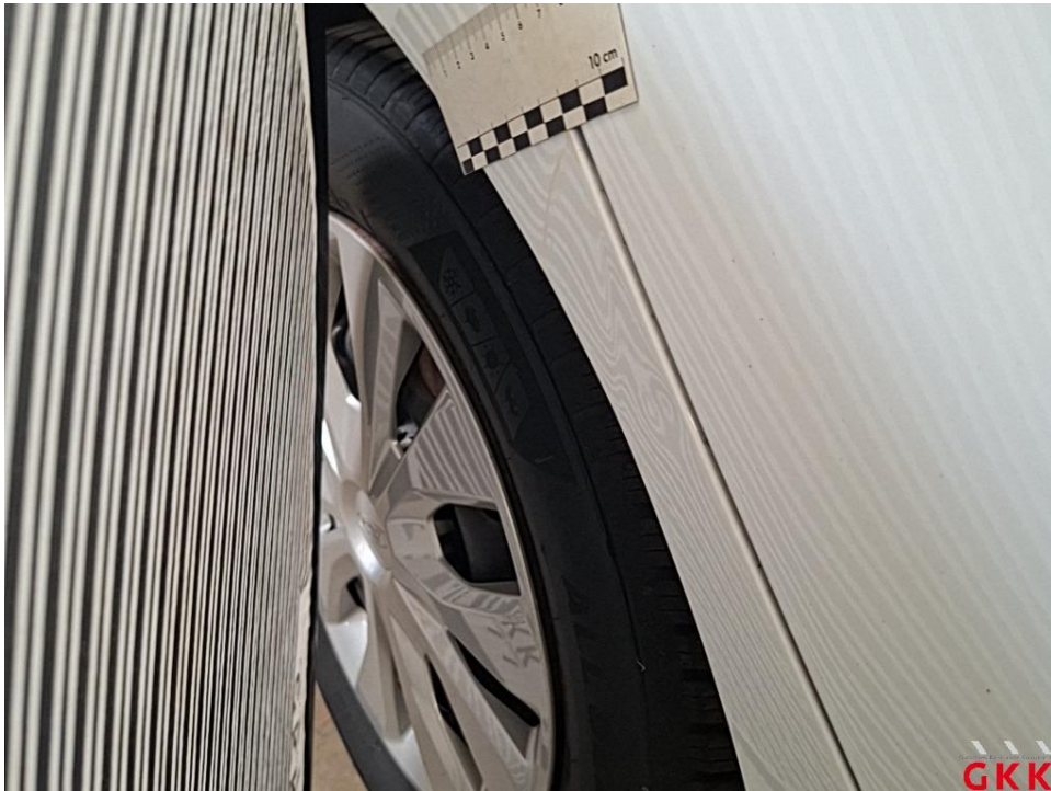
Bild 21 Seitenwand rechts, hinten -unterhalb-, beschädigt, instand setzen - lackieren
