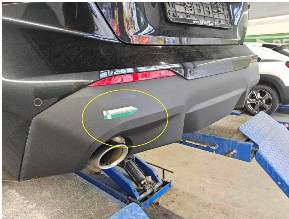
Bild 25 : Stoßfänger hinten, eingekerbt, smart repair
