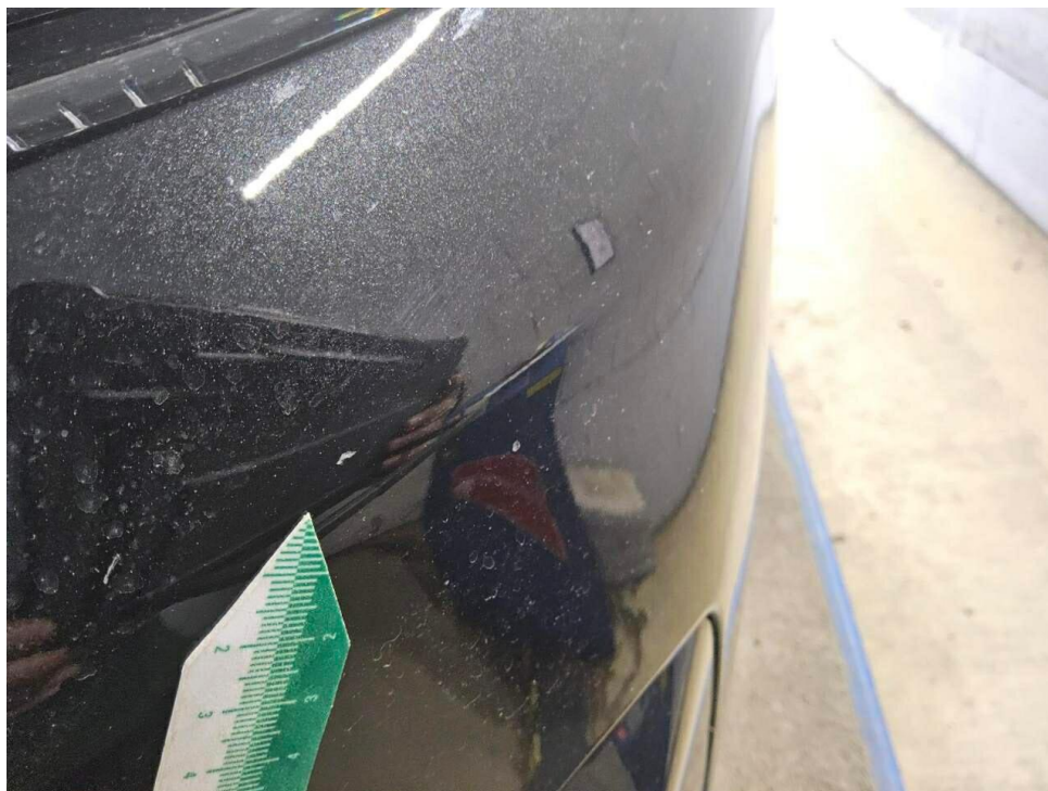
Bild 29 : Stoßfänger vorne Lackierung, Steinschlag, Gebrauchsspur
