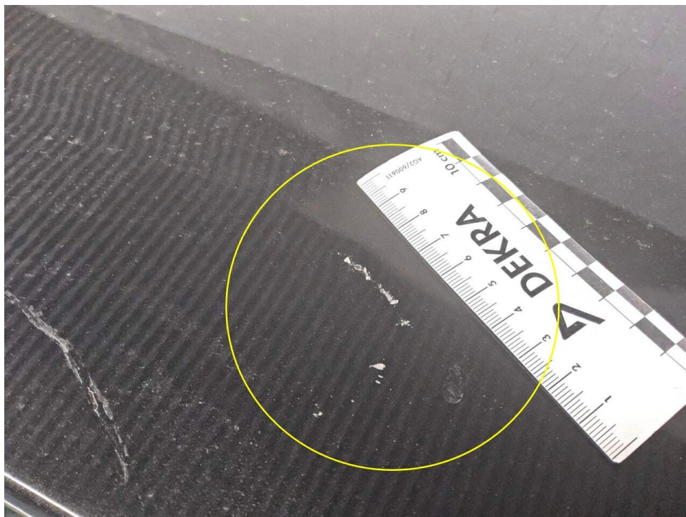
Bild 24 : Motorhaube, eingedellt, instandsetzen und lackieren mit Lackaufbau
