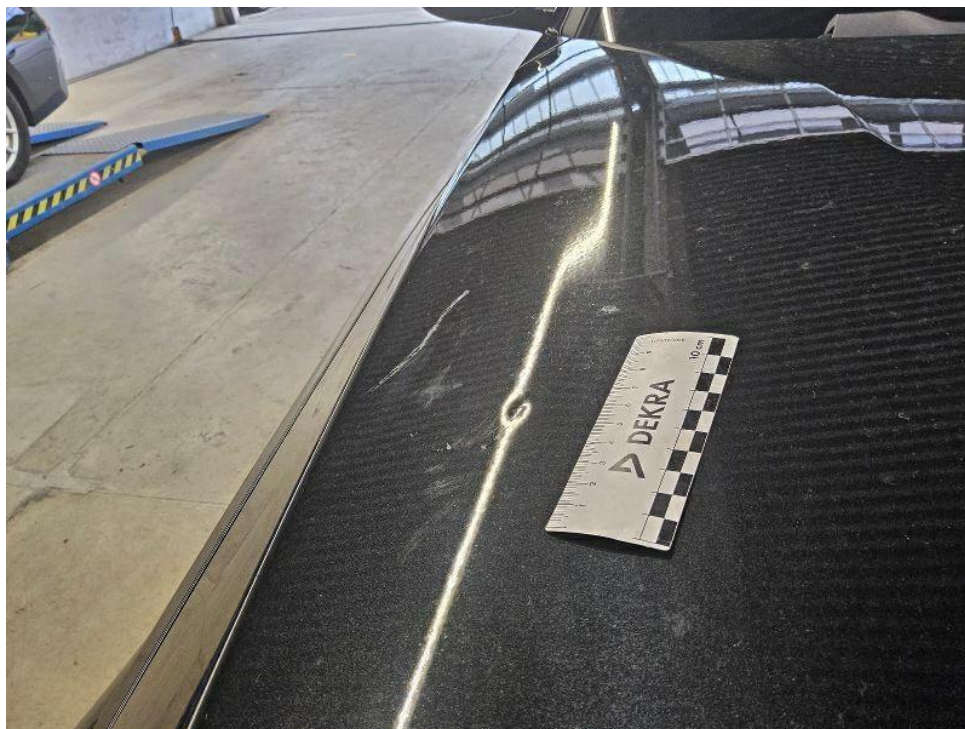
Bild 23 : Motorhaube, eingedellt, instandsetzen und lackieren mit Lackaufbau
