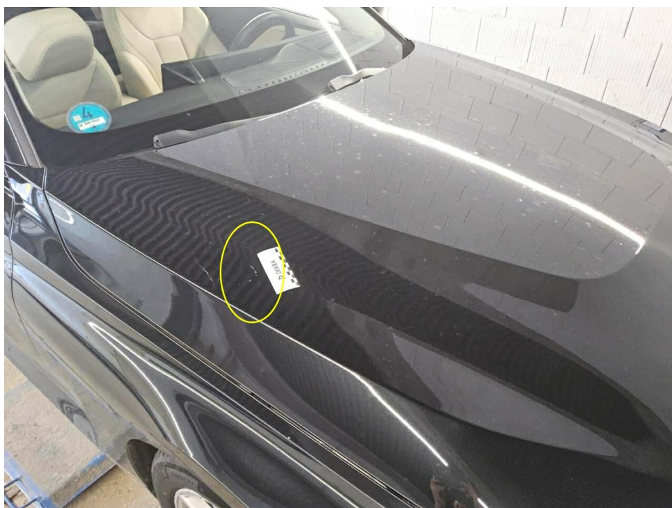
Bild 22 : Motorhaube, eingedellt, instandsetzen und lackieren mit Lackaufbau
