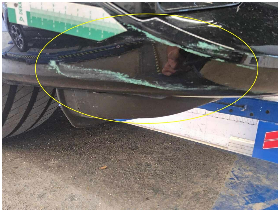
Bild 15 : Frontspoiler Lackierung, verschrommt, lackieren mit Lackaufbau
