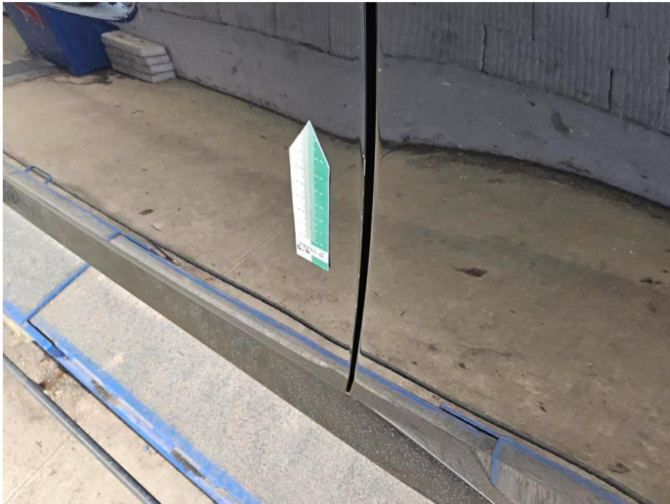
Bild 19 : Tür vorne links Türkante, zerkratzt, Gebrauchsspur
