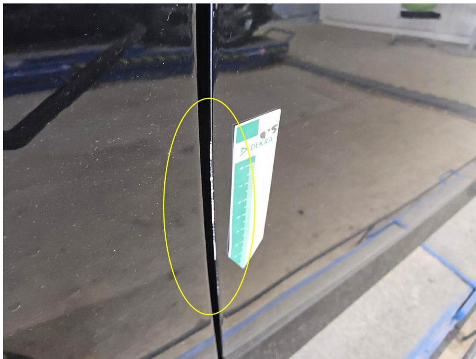
Bild 17 : Tür vorne rechts Türkante, zerkratzt, smart repair
