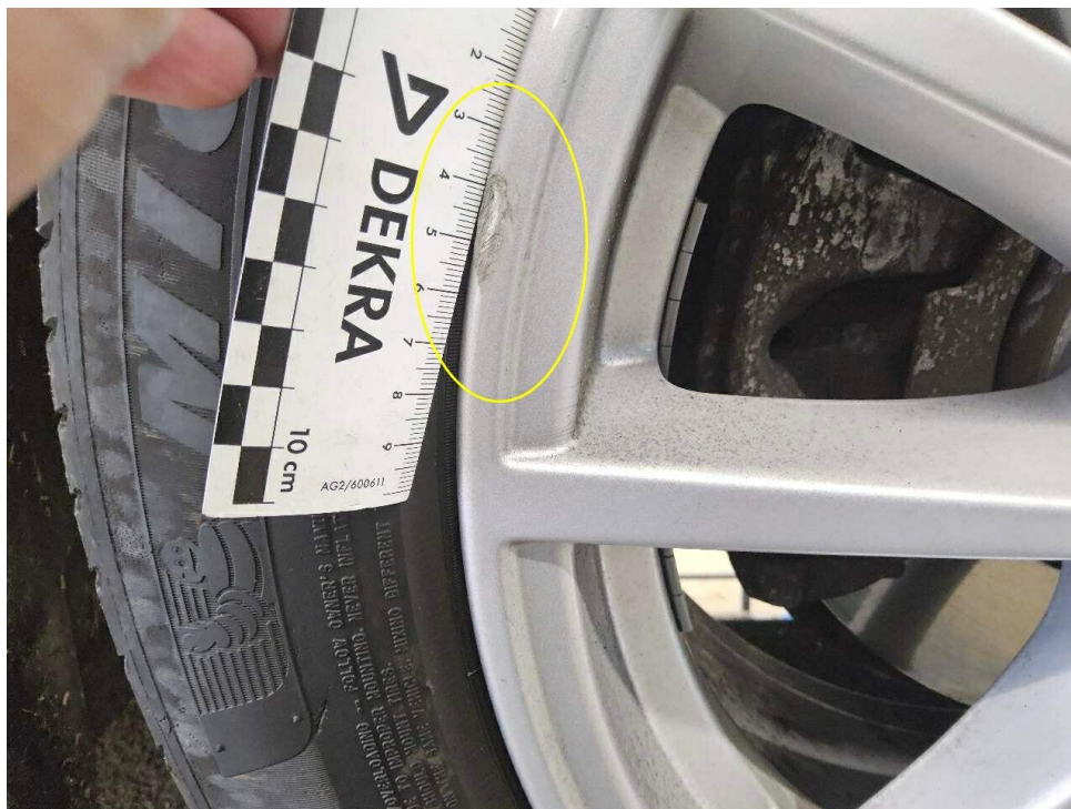
Bild 33 : LM Felge vorne rechts zerkratzt, Sommer
