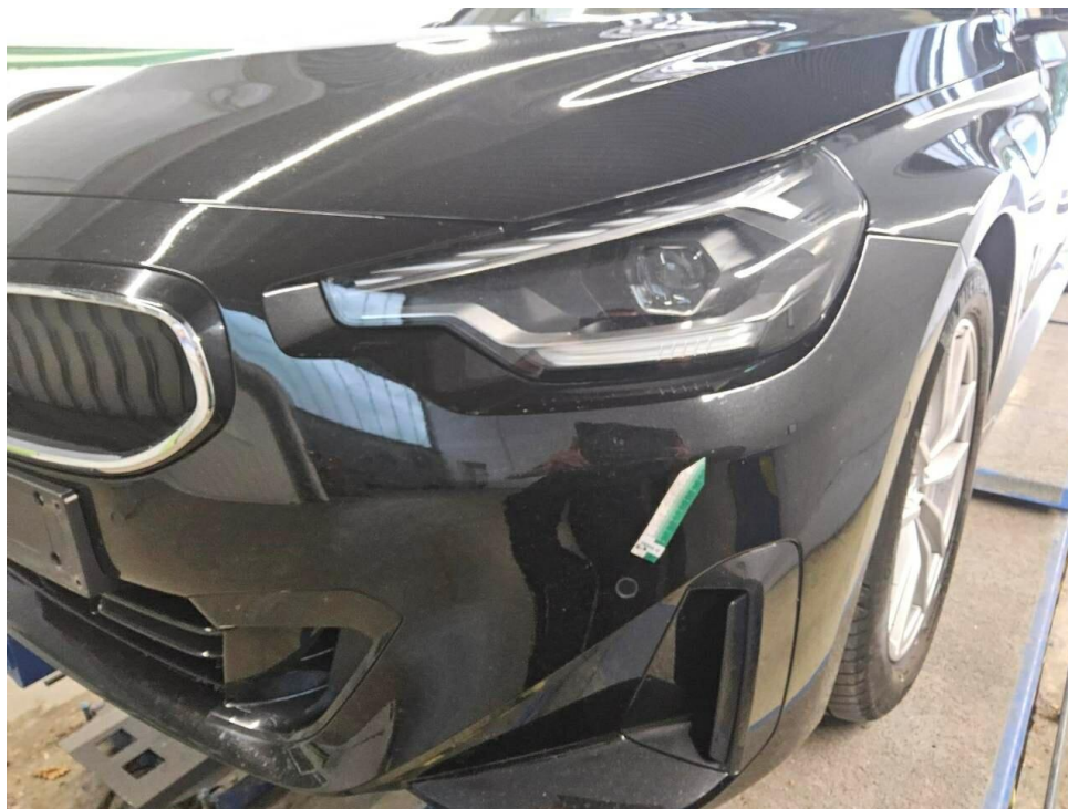
Bild 28 : Stoßfänger vorne Lackierung, Steinschlag, Gebrauchsspur
