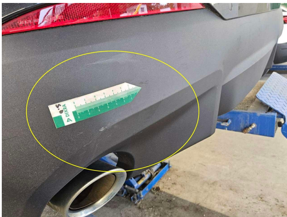
Bild 26 : Stoßfänger hinten, eingekerbt, smart repair
