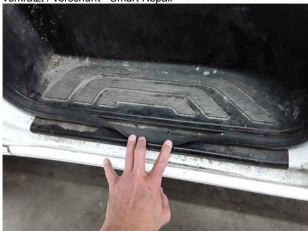
Beschädigung #4: Tür vorn links: Türdichtung - gebrochen / gerissen - erneuern
