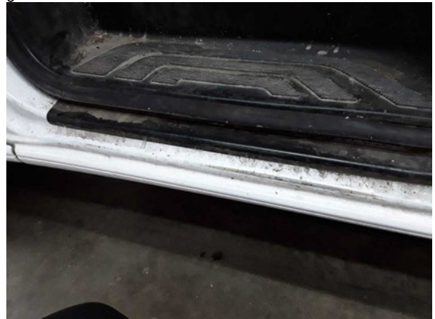
Beschädigung #12: Schweller links: Einstieg - verkratzt / versch... - lackieren
