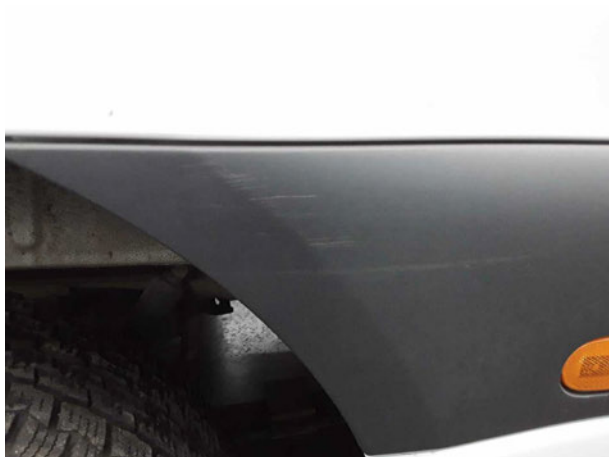
Beschädigung #1: Seitenwand rechts: Schutzleiste (Vorn) - verkratzt / verschürft - Smart Repair
