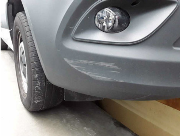
Beschädigung #19: Stossfänger vorn: Stossfänger vorn (Mehrkosten können entstehen) - verkratzt / verschürft - erneuern
