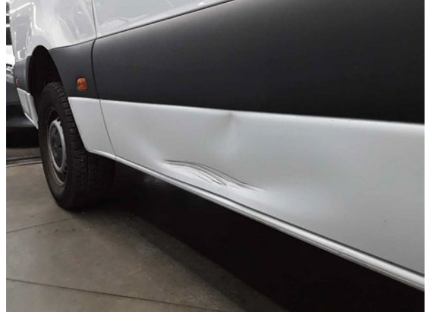
Beschädigung #21: Schiebetür rechts: Schiebetür - verformt - erneuern
