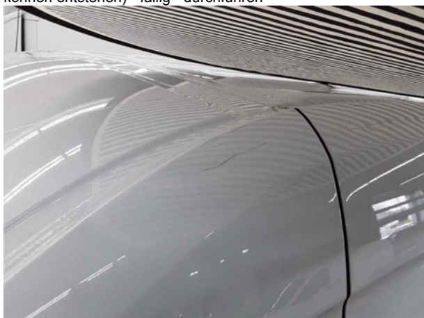
Beschädigung #18: Fahrzeugdach: Dach (Seitenteil VL und mitte) - Delle / Lackschaden - instandsetzen und lackieren
