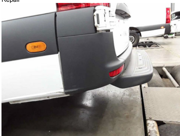
Beschädigung #8: Stossfänger hinten: Stossfänger hinten links - verkratzt / verschürft - erneuern
