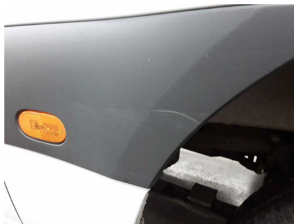
Beschädigung #2: Seitenwand links: Schutzleiste (Mitte,hinten) - verkratzt / verschürft - Smart Repair
