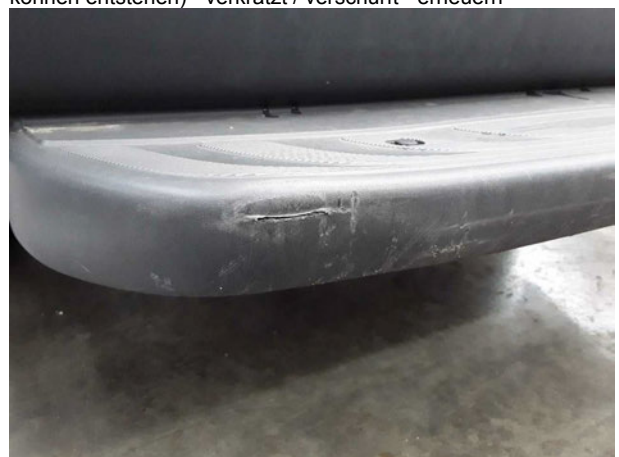
Beschädigung #16: Stossfänger hinten: Verkl. Stossfänger Auftritt mit Parktronic (Mehrkosten können entstehen) - beschädigt -
