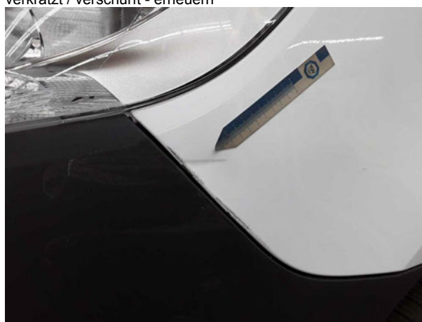
Beschädigung #9: Kotflügel links: Kotflügel links - Delle / Lackschaden - Smart Repair
