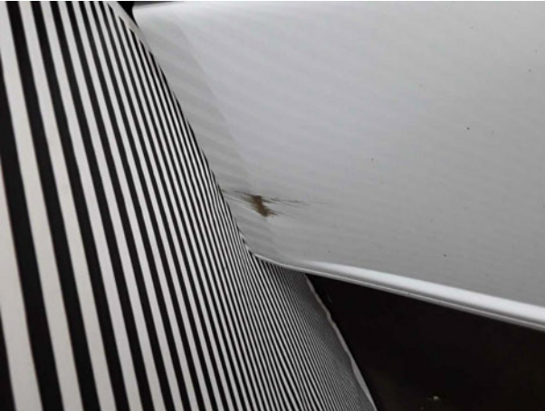
Beschädigung #14: Seitenwand links: Seitenwand (Hinten unterhalb) - Delle / Lackschaden - instandsetzen und lackieren
