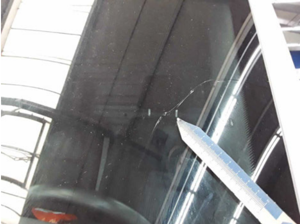
Beschädigung #20: Verglasung: Frontscheibe mit Spurhalteassistent - Steinschlag - erneuern
