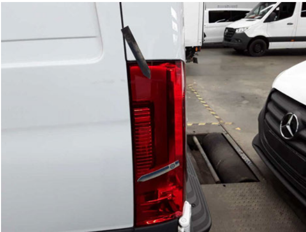
Beschädigung #10: Heckleuchte: Heckleuchte links - gebrochen / gerissen - erneuern
