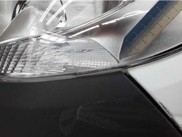
Beschädigung #15: Scheinwerfer: Scheinwerfer links (Mehrkosten können entstehen) - verkratzt / verschürft - erneuern
