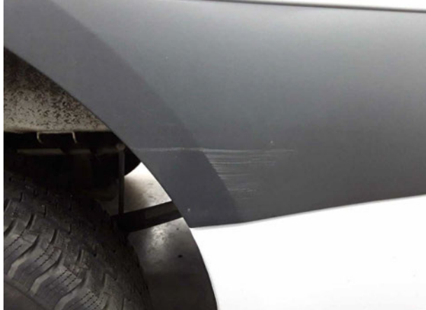
Beschädigung #2: Seitenwand links: Schutzleiste (Mitte,hinten) - verkratzt / verschürft - Smart Repair
