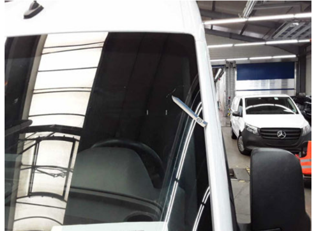
Beschädigung #20: Verglasung: Frontscheibe mit Spurhalteassistent - Steinschlag - erneuern
