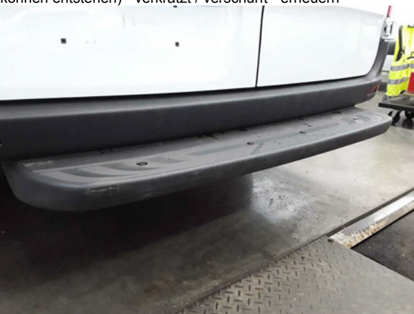
Beschädigung #16: Stossfänger hinten: Verkl. Stossfänger Auftritt mit Parktronic (Mehrkosten können entstehen) - beschädigt - erneuern
