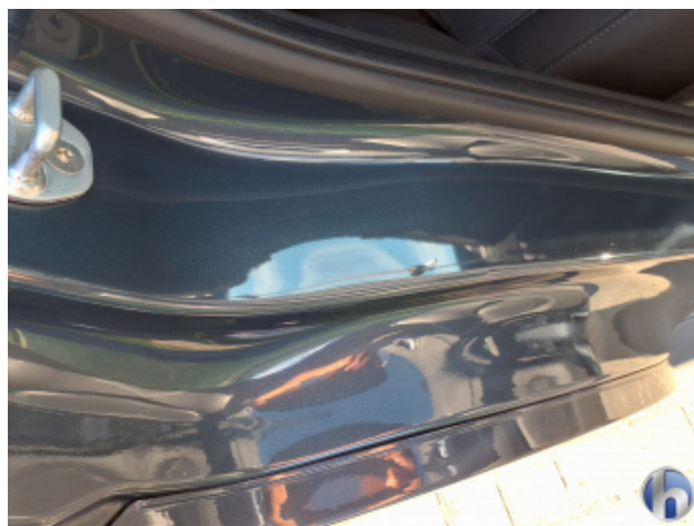
2. Türeinstieg Hinten - Rechts Kratzer - Smart Repair
