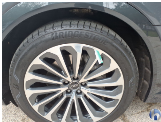
2. Felge Vorne - Links Kratzer - Smart Repair
