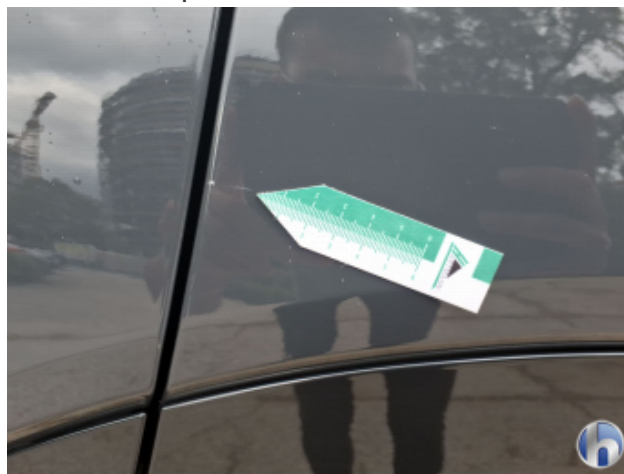
12. Seitenwand - Hinten - Links Kratzer - Smart Repair
