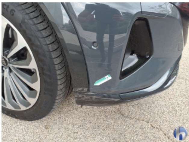
8. Stoßfänger Vorne Beschädigt - Instandsetzen und Lackieren
