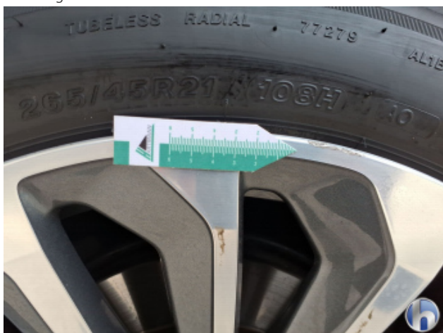
1. Felge Hinten - Rechts Kratzer - Smart Repair
