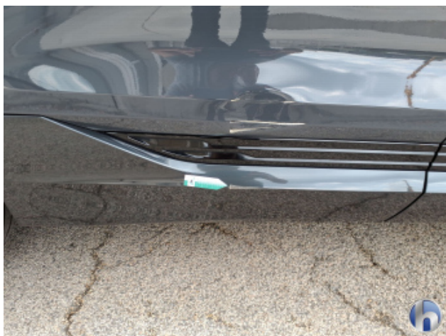
5. Tür Hinten - Rechts Beschädigt - Instandsetzen und Lackieren
