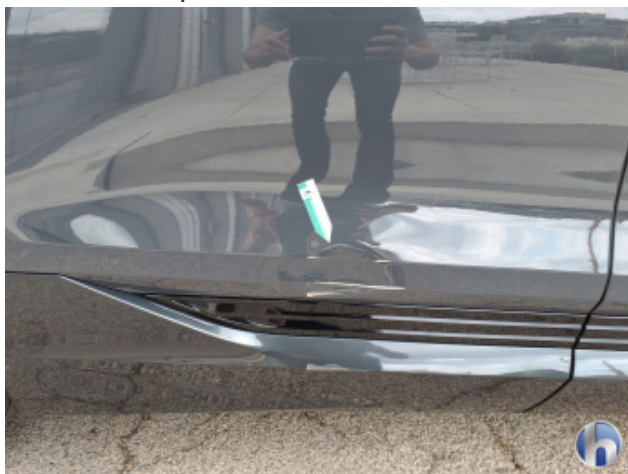
5. Tür Hinten - Rechts Beschädigt - Instandsetzen und Lackieren
