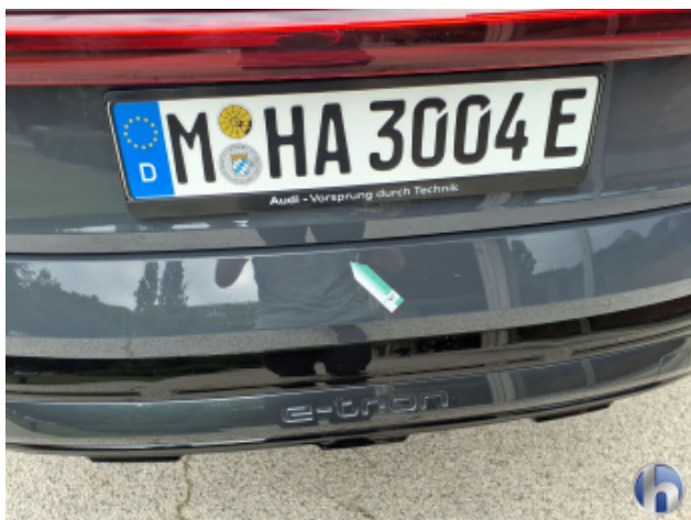
4. Stoßfänger Hinten Kratzer - Smart Repair
