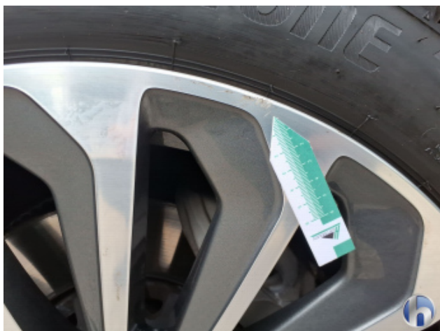
2. Felge Vorne - Links Kratzer - Smart Repair
