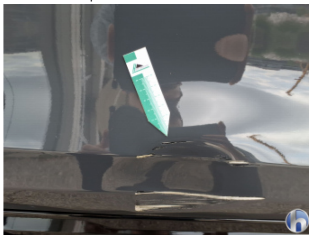
5. Tür Hinten - Rechts Beschädigt - Instandsetzen und Lackieren
