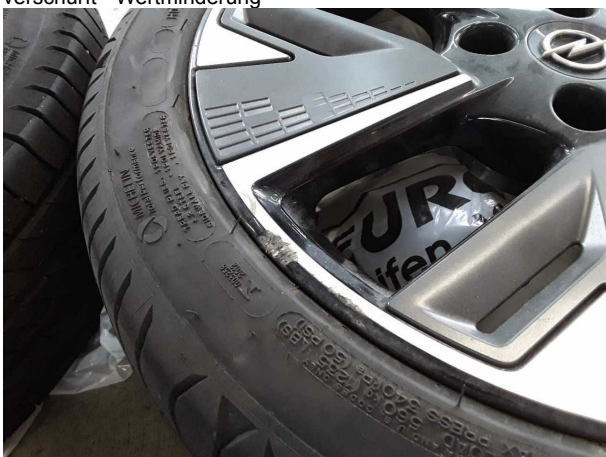
Beschädigung #7: 2.Radsatz: 3 Leichtmetallfelgen - verkratzt / verschürft - Wertminderung
