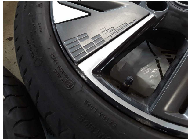
Beschädigung #7: 2.Radsatz: 3 Leichtmetallfelgen - verkratzt / verschürft - Wertminderung
