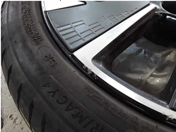
Beschädigung #7: 2.Radsatz: 3 Leichtmetallfelgen - verkratzt / verschürft - Wertminderung
