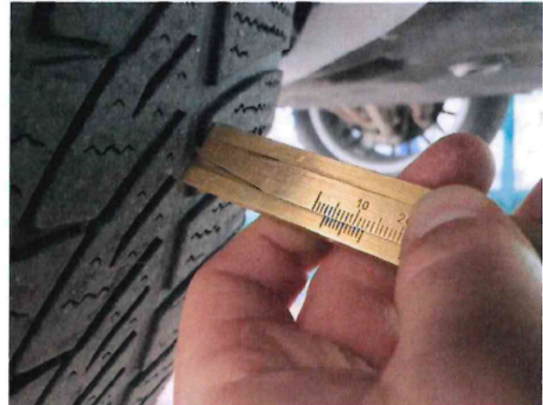
Beschädigung #13: Rad/Reifen: Reifen vorn (Unter 4mm, bei Verkauf erneuern) - verschlissen - erneuern
