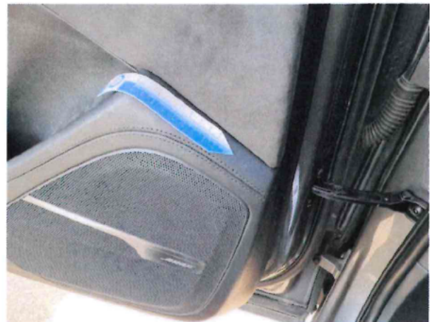
Beschädigung #5: Verkleidungen/Abdeckungen: Türverkleidung hinten links - Kratzer - Wertminderung
