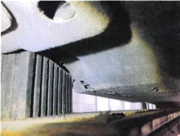
Beschädigung #11: Karosserie: Unterbodenverkleidung (Rechts) - Löcher - erneuern
