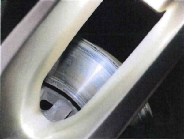
Beschädigung #15: Bremsanlage: Bremsscheiben und Beläge vorn (Laufbild der Bremsscheibe, bei Verkauf erneuern) -
