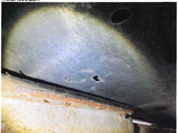
Beschädigung #11: Karosserie: Unterbodenverkleidung (Rechts) - Löcher - erneuern
