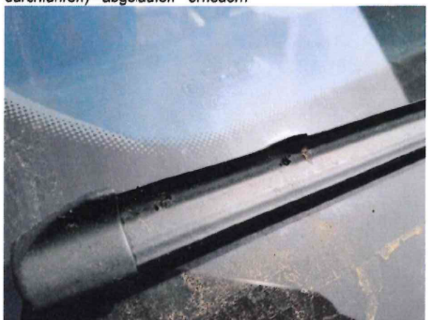
Beschädigung #7: Scheibenreinigung: Scheibenwischerblätter vorn - Marderschaden - erneuern
