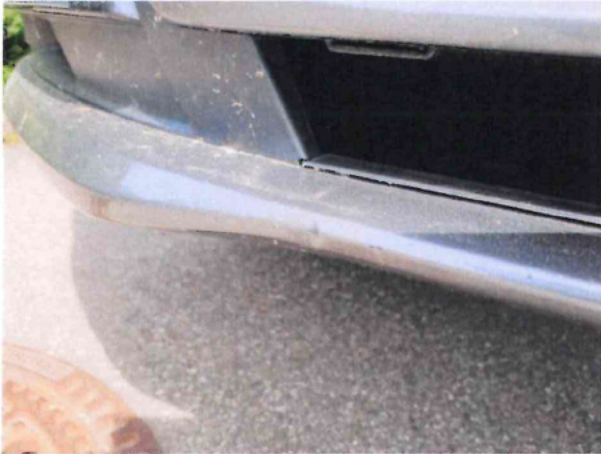
Beschädigung #16: Stossfänger vorn: Stossfänger vorn (+ Blenden, mehrkosten möglich) - verformt - erneuern
