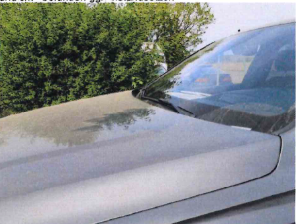
Beschädigung #3: Motorhaube: Motorhaube (Lack Wellig) - Lackmangel - befunden ggf. instandsetzen
