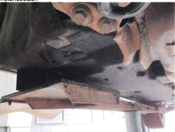
Beschädigung #11: Karosserie: Unterbodenverkleidung (Rechts) - Löcher - erneuern
