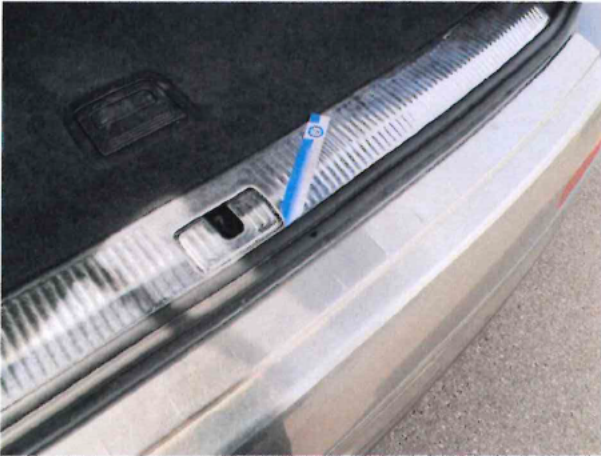
Beschädigung #8: Heckklappe/-tür: Dichtung - gebrochen / gerissen - erneuern
