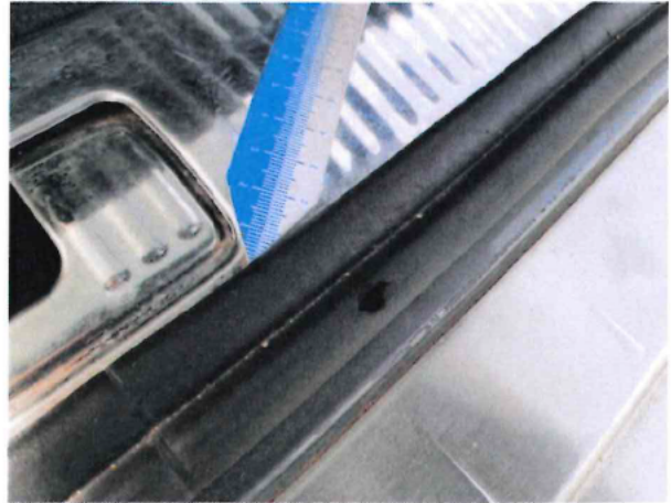
Beschädigung #8: Heckklappe/-tür: Dichtung - gebrochen / gerissen - erneuern
