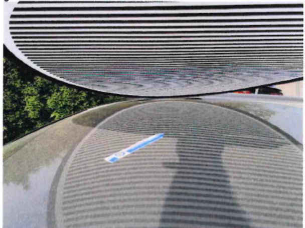
Beschädigung #9: Fahrzeugdach: Dach - Delle(n) - sanft instandsetzen
