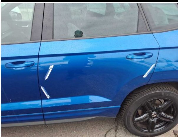
Beschädigung #6: Tür hinten links: Tür - verkratzt / verschürft - instandsetzen und lackieren
