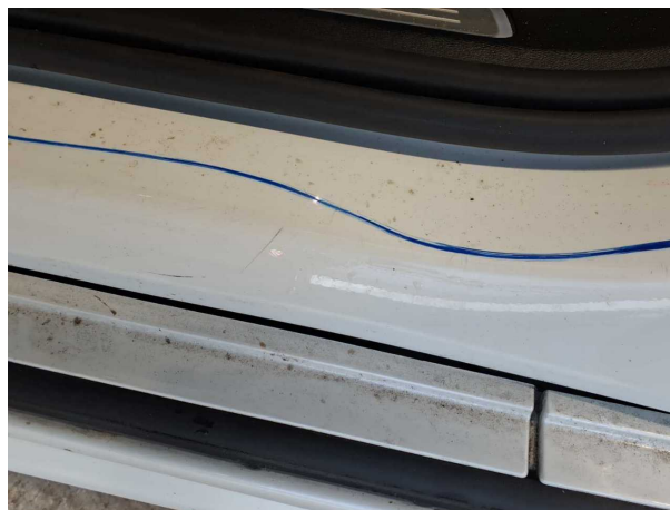
Beschädigung #6: Seitenwand links: Einstieg - Delle / Lackschaden - Smart Repair
