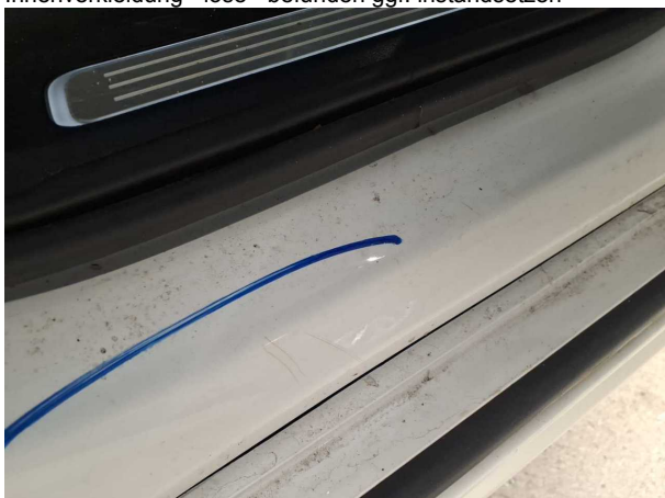
Beschädigung #2: Seitenwand rechts: Einstieg - Kratzer - Smart Repair
