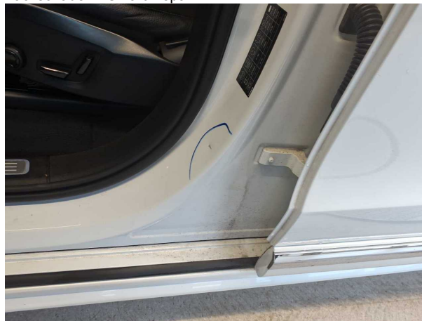
Beschädigung #7: Schweller links: Einstieg - Delle / Lackschade... Smart Repair
