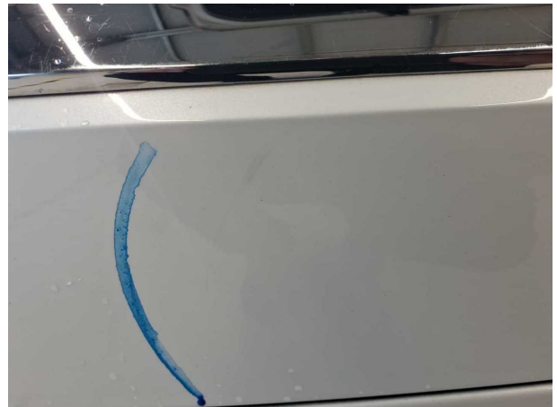
Beschädigung #12: Stossfänger hinten: Stossfänger hinten - Kratzer - lackieren
