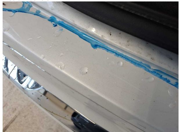
Beschädigung #12: Stossfänger hinten: Stossfänger hinten - Kratzer - lackieren
