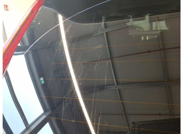
Beschädigung #13: Verglasung: Heckscheibe - verkratzt / verschürft - erneuern
