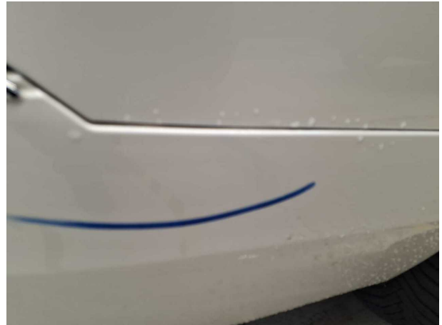
Beschädigung #12: Stossfänger hinten: Stossfänger hinten - Kratzer - lackieren
