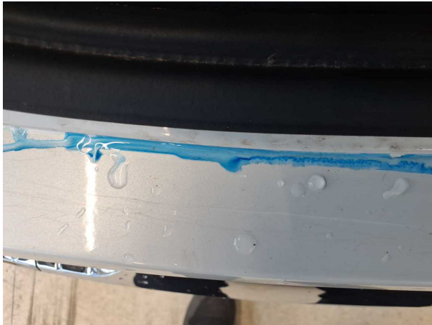
Beschädigung #12: Stossfänger hinten: Stossfänger hinten - Kratzer - lackieren
