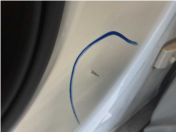
Beschädigung #7: Schweller links: Einstieg - Delle / Lackschaden - Smart Repair
