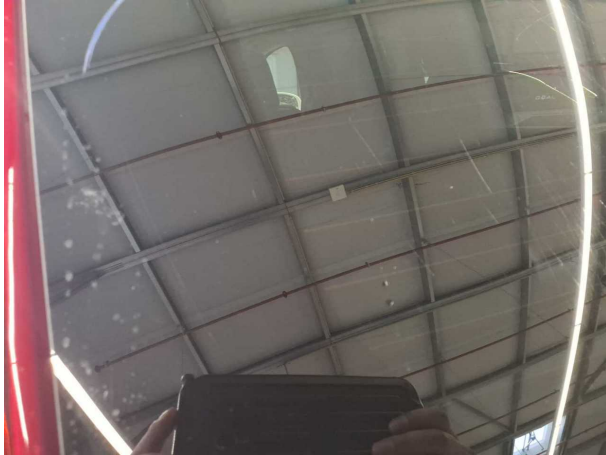
Beschädigung #13: Verglasung: Heckscheibe - verkratzt / verschürft - erneuern
