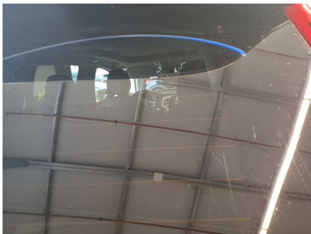
Beschädigung #13: Verglasung: Heckscheibe - verkratzt / verschürft - erneuern
