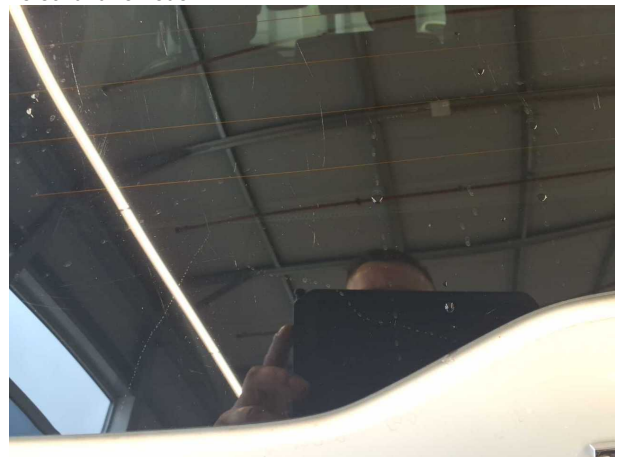
Beschädigung #13: Verglasung: Heckscheibe - verkratzt / verschürft - erneuern
