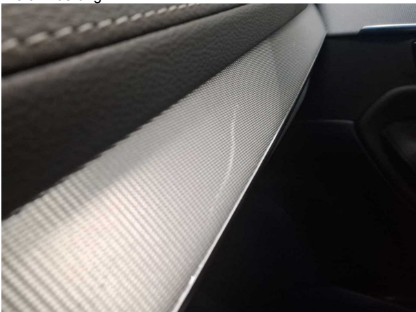
Beschädigung #8: Instrumententafel: Blende - verkratzt / verschürft - Wertminderung
