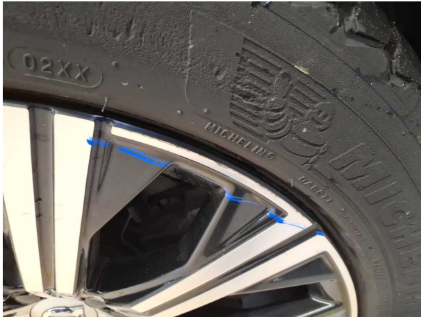
Beschädigung #5: Rad/Reifen: Leichtmetallfelge vorn rechts - Kratz... Wertminderung
