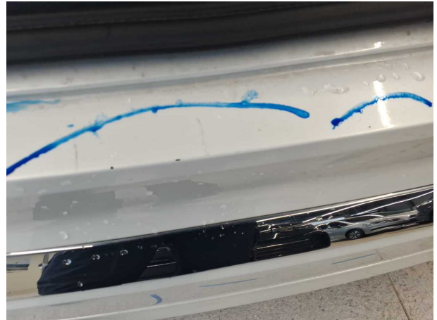
Beschädigung #12: Stossfänger hinten: Stossfänger hinten - Kratzer - lackieren
