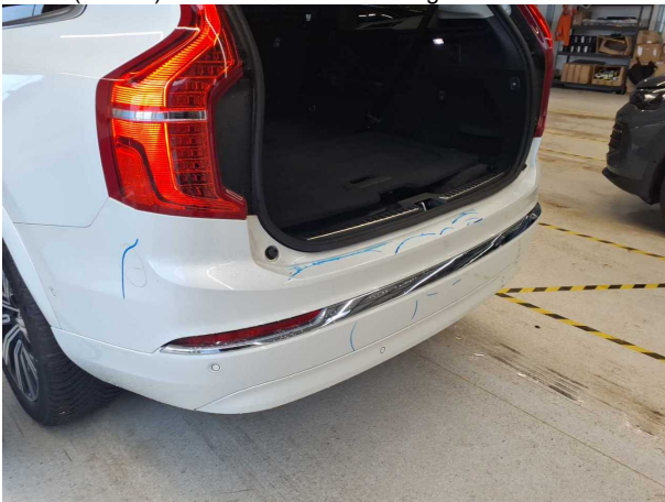
Beschädigung #12: Stossfänger hinten: Stossfänger hinten - Kratzer - lackieren
