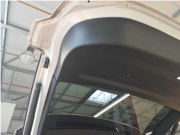
Beschädigung #3: Verkleidungen/Abdeckungen: Heckdeckel, Innenverkleidung - Kratzer - Wertminderung
