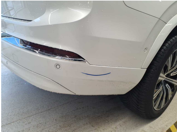
Beschädigung #12: Stossfänger hinten: Stossfänger hinten - Kratzer - lackieren
