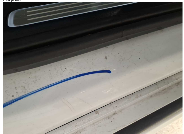
Beschädigung #2: Seitenwand rechts: Einstieg - Kratzer - Smart Repair
