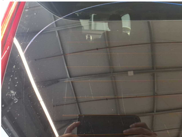
Beschädigung #13: Verglasung: Heckscheibe - verkratzt / verschürft - erneuern
