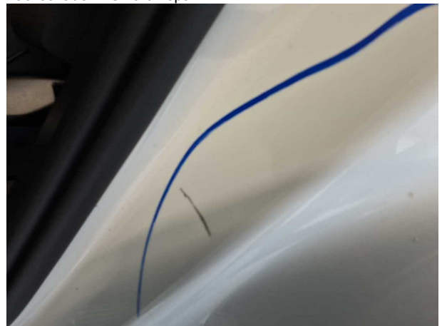
Beschädigung #6: Seitenwand links: Einstieg - Delle / Lackschaden - Smart Repair
