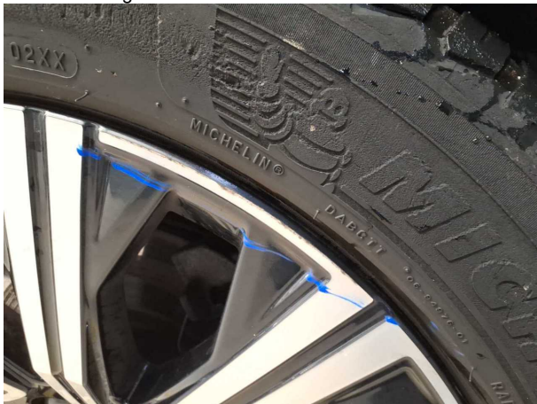
Beschädigung #5: Rad/Reifen: Leichtmetallfelge vorn rechts - Kratz... Wertminderung
