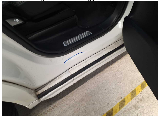
Beschädigung #2: Seitenwand rechts: Einstieg - Kratzer - Smart Repair
