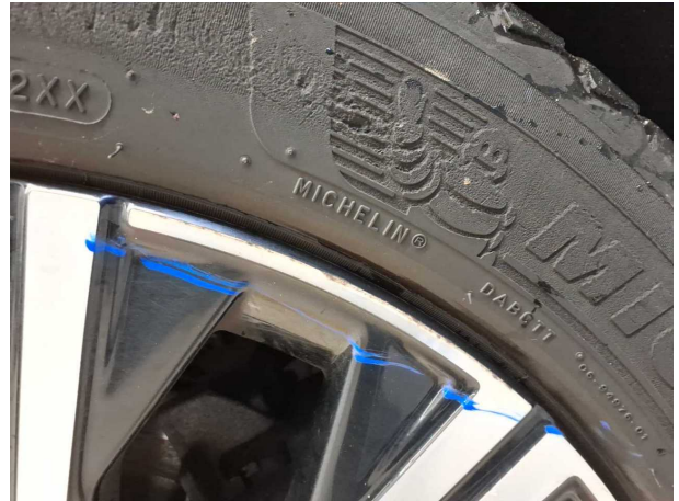
Beschädigung #5: Rad/Reifen: Leichtmetallfelge vorn rechts - Kratzer - Wertminderung
