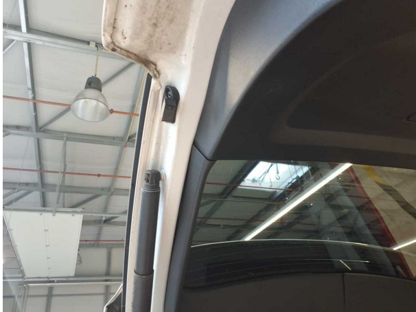
Beschädigung #1: Verkleidungen/Abdeckungen: Heckdeckel, Innenverkleidung - lose - befunden ggf. instandsetzen
