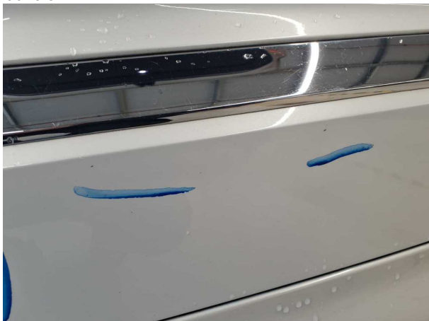
Beschädigung #12: Stossfänger hinten: Stossfänger hinten - Kratzer - lackieren
