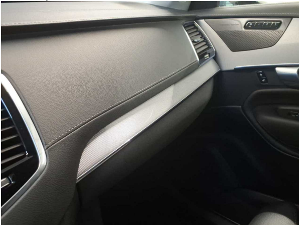
Beschädigung #8: Instrumententafel: Blende - verkratzt / verschürft - Wertminderung
