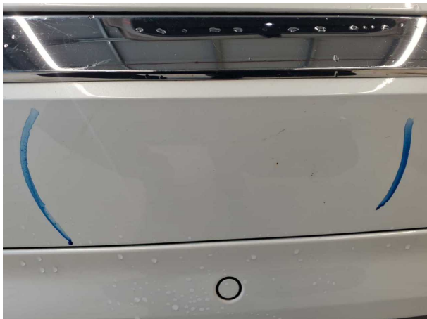
Beschädigung #12: Stossfänger hinten: Stossfänger hinten - Kratzer - lackieren
