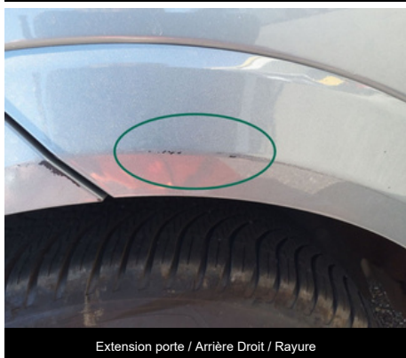
Extension porte / Arrière Droit / Rayure
