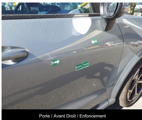
Porte / Avant Droit / Enfoncement
