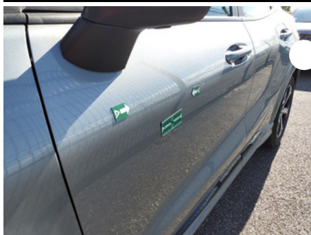
Porte / Avant Gauche / Enfoncement
