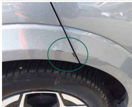
Extension d'aile / Arrière Droit / Rayure
