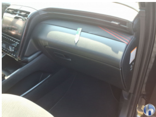
7. Verkleidung Kratzer - Smart Repair
