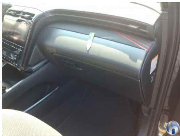
7. Verkleidung Kratzer - Smart Repair
