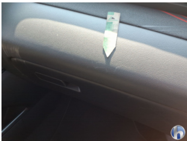
7. Verkleidung Kratzer - Smart Repair
