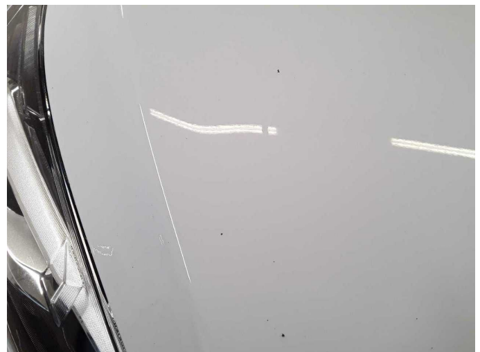
Damage 5: Bonnet: Bonnet (Übermäßige Steinschläge) - Stone chips - Paint
