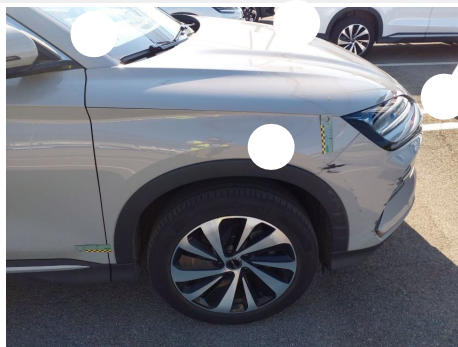
Parafango / Anteriore Destro / Rientranza
