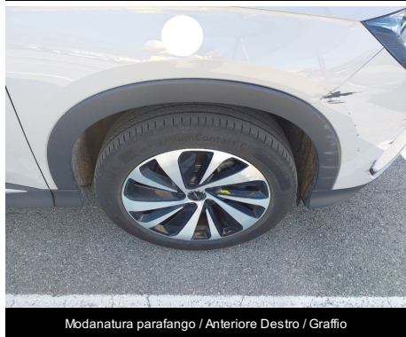
Parafango / Anteriore Destro / Rientranza
