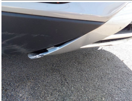
Parte inferiore paraurti / Anteriore / Rotto
