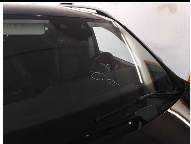
Beschädigung #9: Verglasung: Frontscheibe (Rissbildung) - Steinschlag - erneuern
