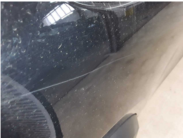
Beschädigung #4: Tür hinten rechts: Tür - Kratzer - auslegen / polieren
