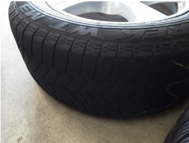
Beschädigung #2: 2.Radsatz: 2 Reifen - verschlissen - kein Abzug
