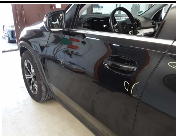
Beschädigung #7: Tür vorn links: Tür - Delle(n) - sanft instandsetzen
