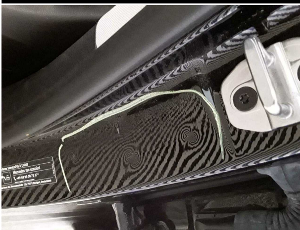
Beschädigung #8: Schweller links: Einstieg - Delle / Lackschade... instandsetzen und lackieren
