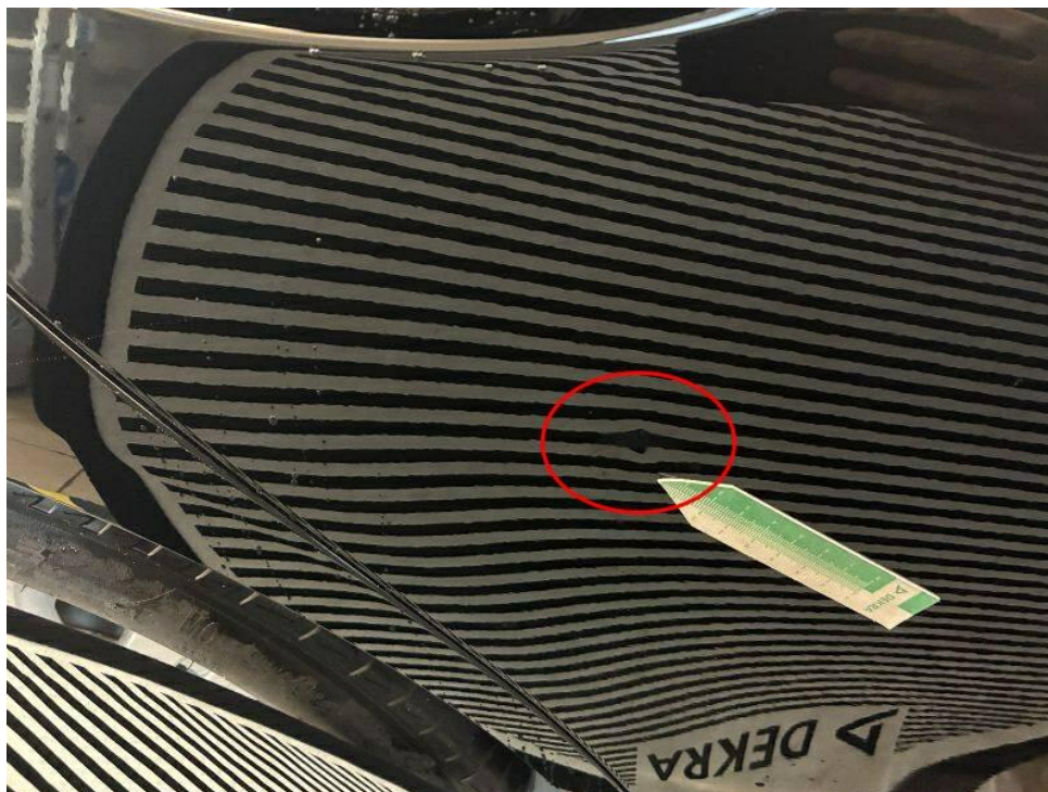
Bild 21 : Tür hinten rechts, eingedellt, drücken
