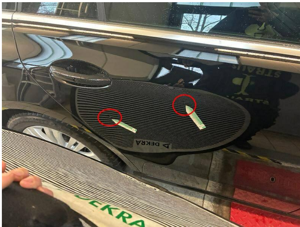
Bild 20 : Tür hinten rechts, eingedellt, drücken
