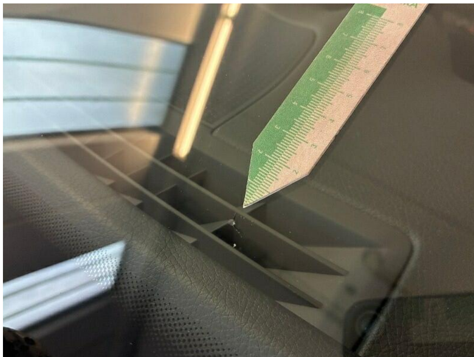
Bild 18 : Frontscheibe, Steinschlag, Gebrauchsspur wurde schon Instandgesetzt
