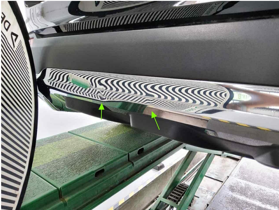
Bild 23 : Stoßfängerunterteil hinten deformiert
