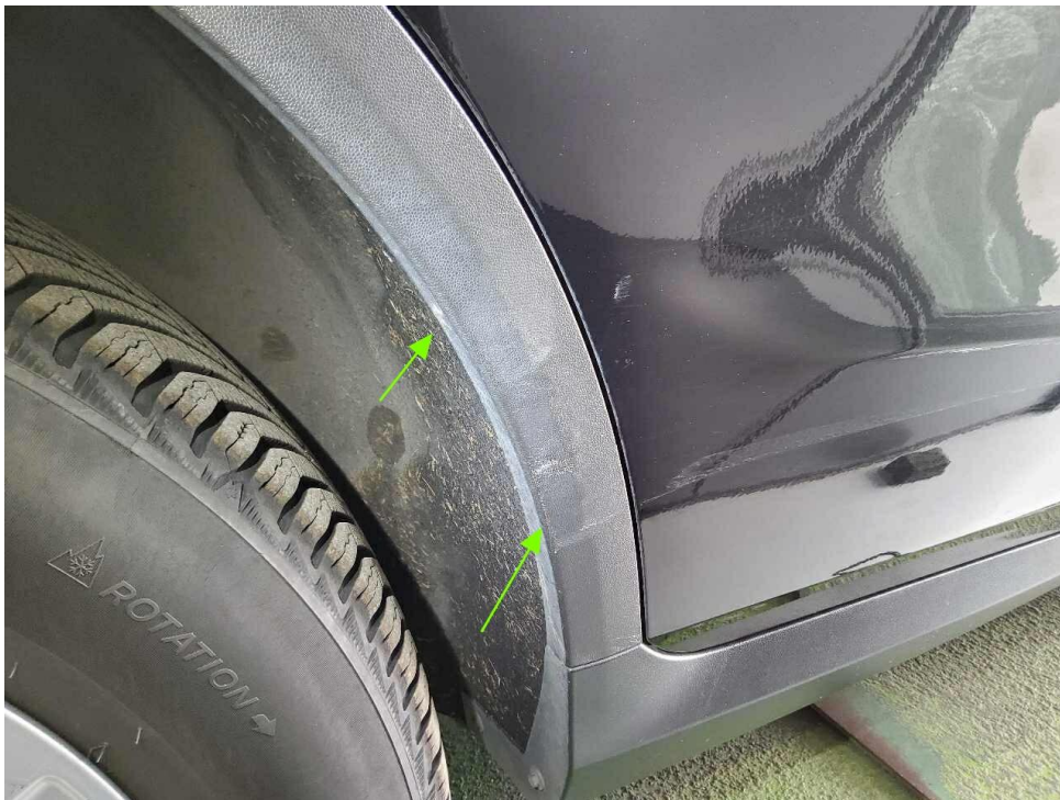
Bild 22 : Radlaufblende HR verschrammt
