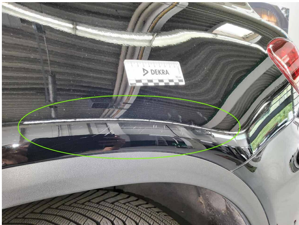
Bild 19 : Seitenteil hinten links Lackierung, zerkratzt, lackieren mit Lackaufbau
