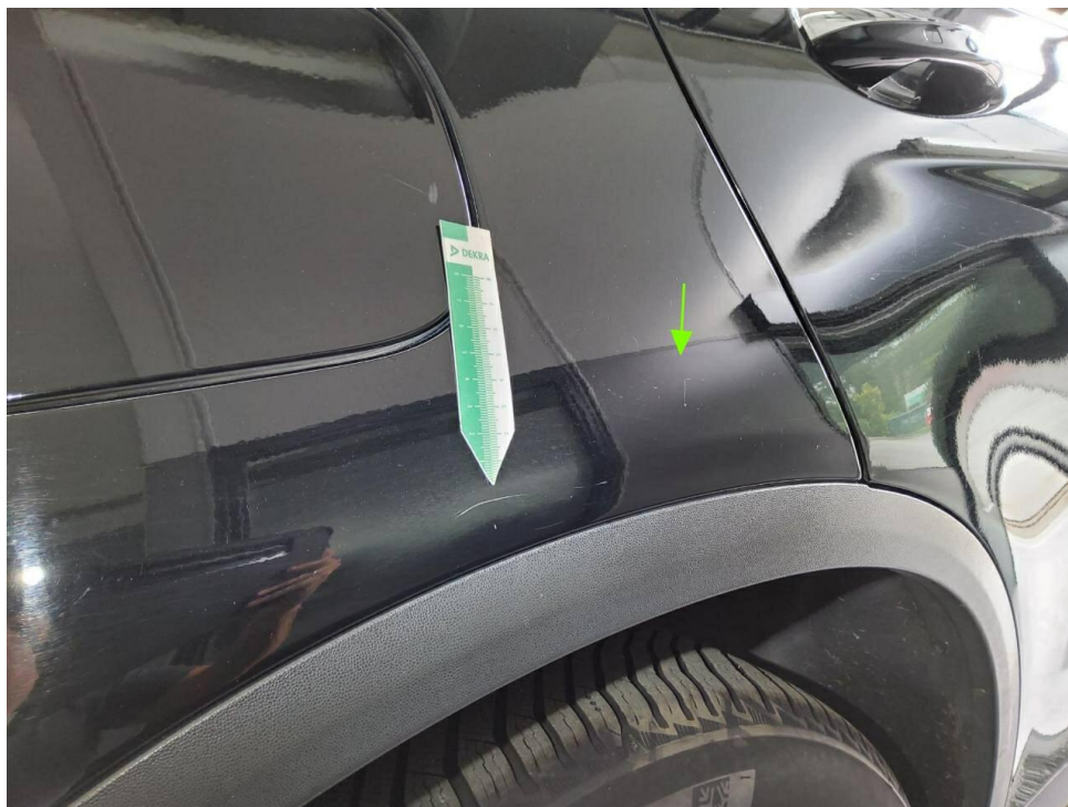
Bild 17 : Seitenteil hinten rechts Lackierung, zerkratzt, lackieren mit Lackaufbau
