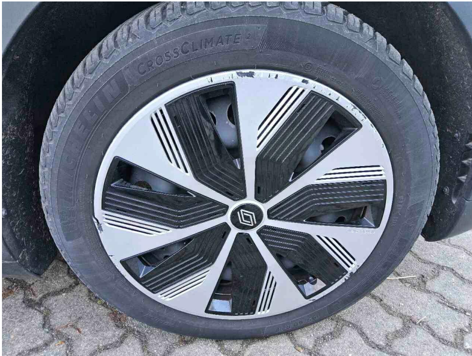
Bild 13 : Felge vorne rechts Radzierdeckel, zerbrochen, erneuern
