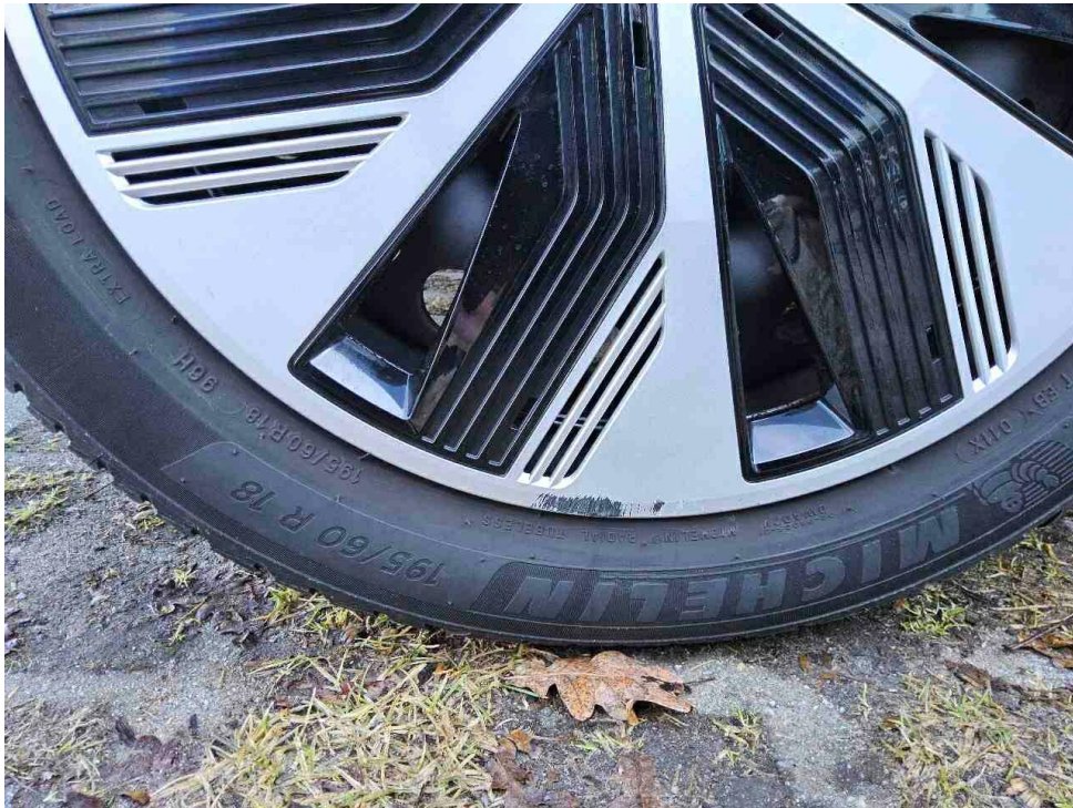
Bild 11 : Felge hinten rechts Radzierdeckel, verschrammt, erneuern
