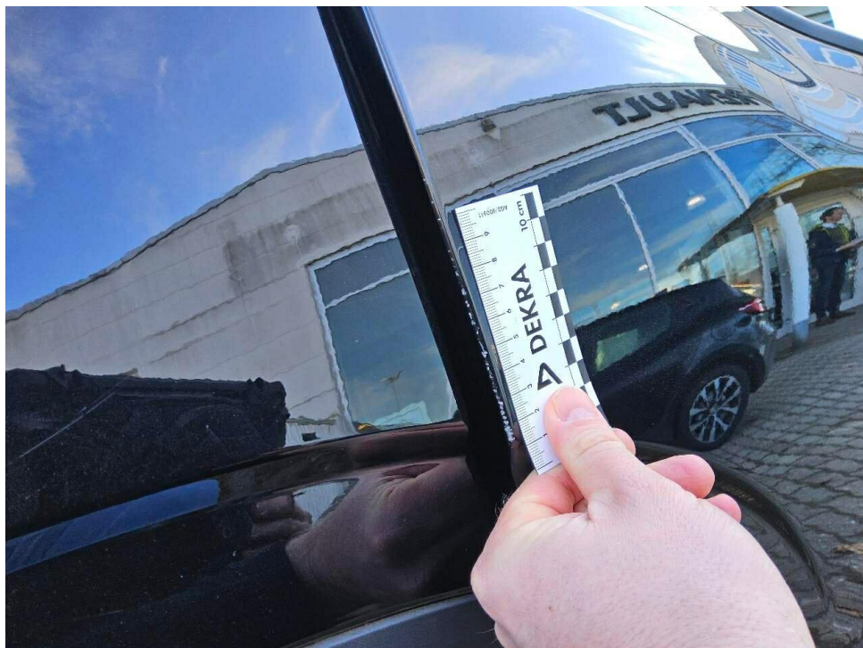
Bild 18 : Tür hinten rechts Türkante, verschrammt, smart repair
