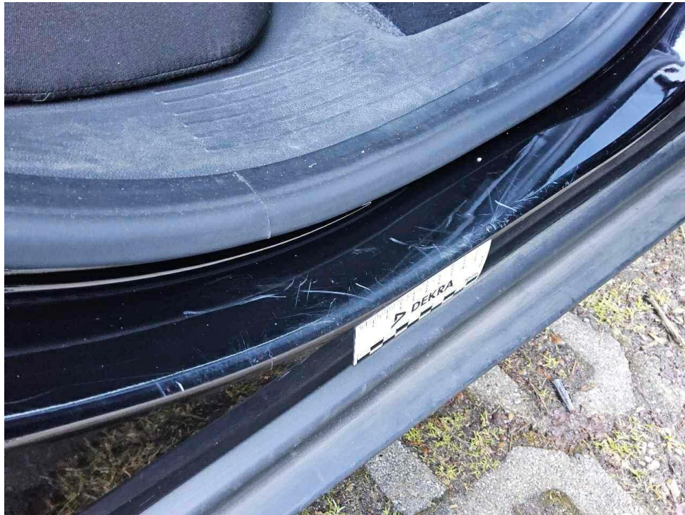
Bild 17 : Tür hinten rechts Einstieg Lackierung, zerkratzt, smart repair
