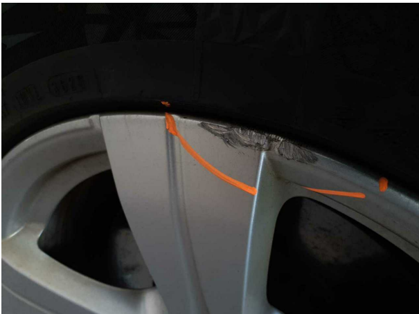
Beschädigung #4: Rad/Reifen: Leichtmetallfelge hinten rechts - verkratzt / verschürft - erneuern
