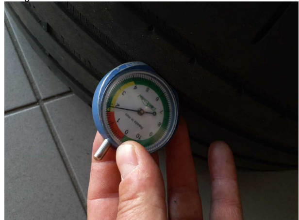
Beschädigung #3: 2.Radsatz: 2 Reifen - verschlissen - erneuern
