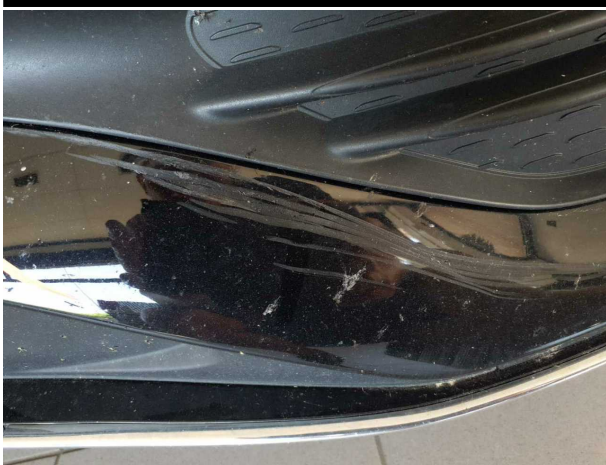
Beschädigung #5: Stossfänger vorn: Stossfänger vorn - verkratzt / verschürft - instandsetzen und lackieren
