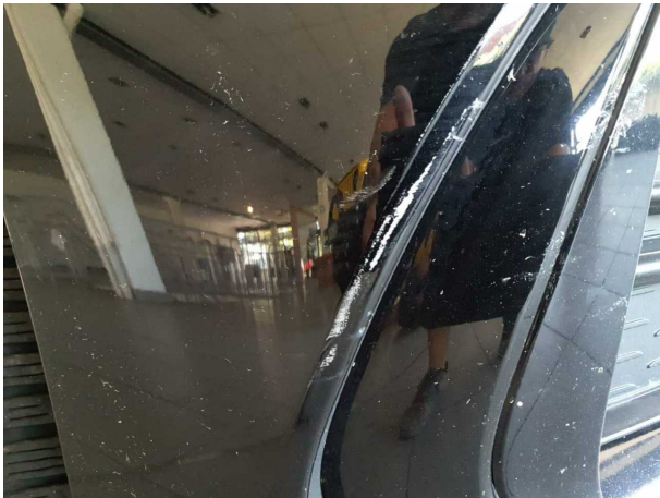
Beschädigung #5: Stossfänger vorn: Stossfänger vorn - verkratzt / verschürft - instandsetzen und lackieren
