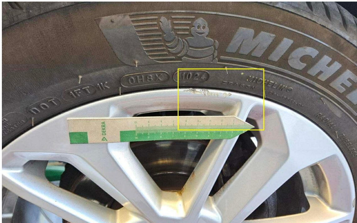
Bild 19 : Felge vorne rechts Lackierung, verschrämmt, lackieren mit Lackaufbau
