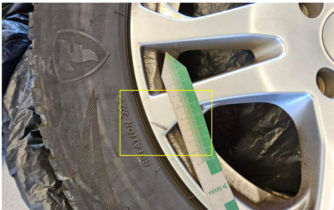
Bild 16 : Felge vorne rechts, verschrammt, lackieren mit Lackaufbau
