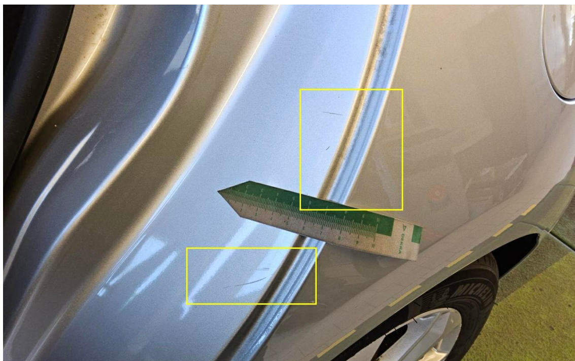
Bild 30 : Tür hinten links Einstieg Lackierung, zerkratzt, lackieren mit Lackaufbau
