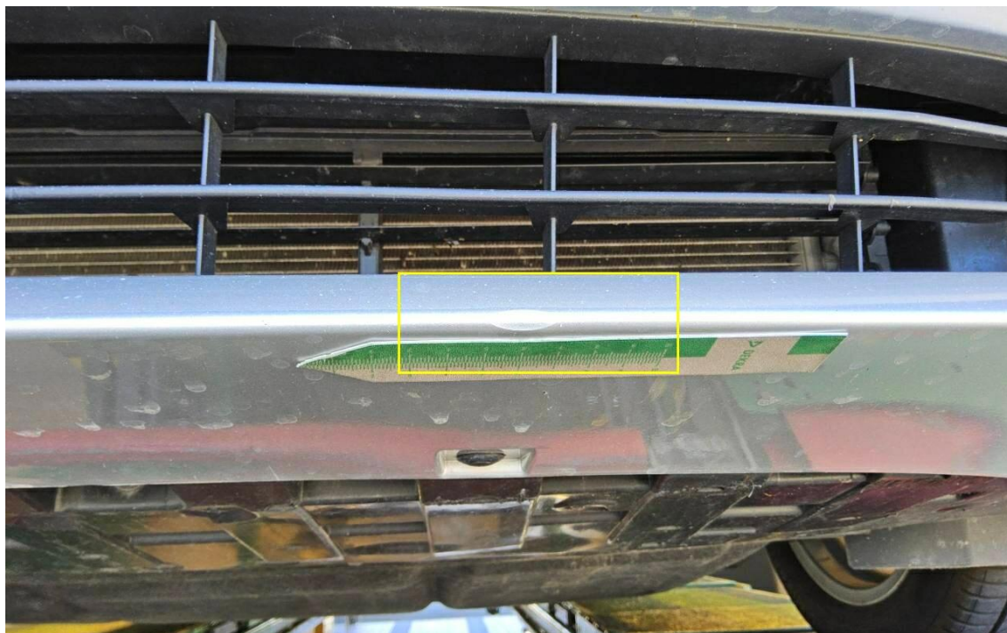
Bild 35 : Stoßfänger vorne, eingedellt, instandsetzen und lackieren mit Lackaufbau
