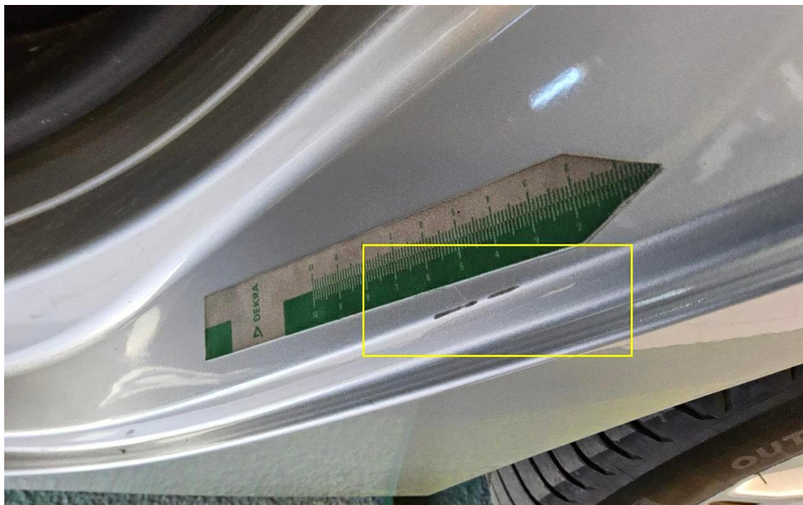
Bild 29 : Tür hinten links Einstieg Lackierung, zerkratzt, lackieren mit Lackaufbau
