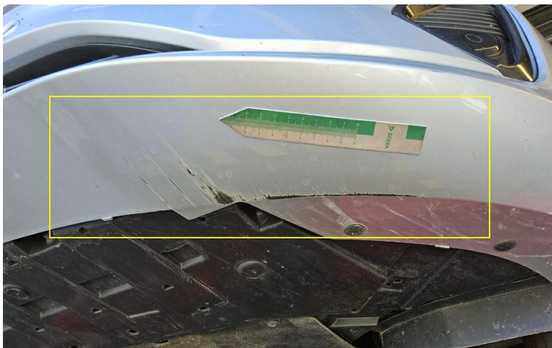
Bild 36 : Stoßfänger vorne, eingedellt, instandsetzen und lackieren mit Lackaufbau
