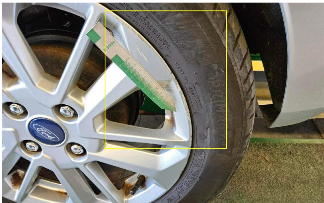
Bild 28 : Felge hinten links Lackierung, verschrammt, lackieren mit Lackaufbau
