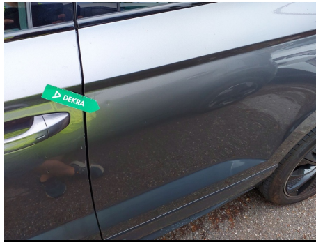
Puerta / Trasero Izquierdo / Abolladura
