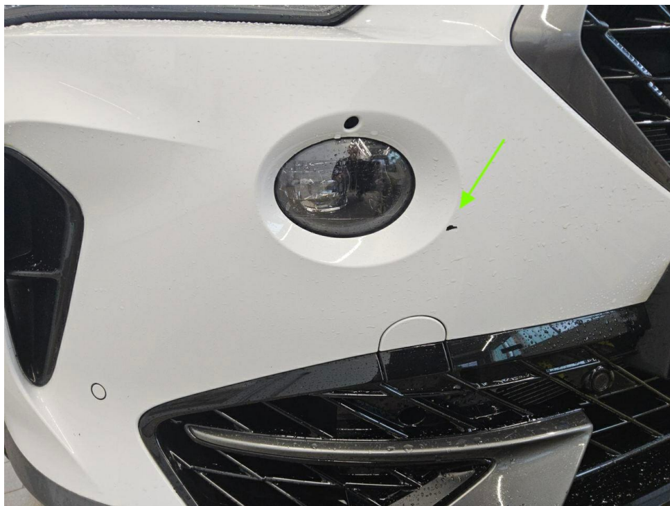
Bild 14 : Stoßfänger vorne Lackierung, zerkratzt, smart repair
