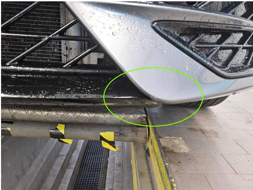
Bild 16 : Frontspoiler Lackierung, verschrammt, Gebrauchsspur
