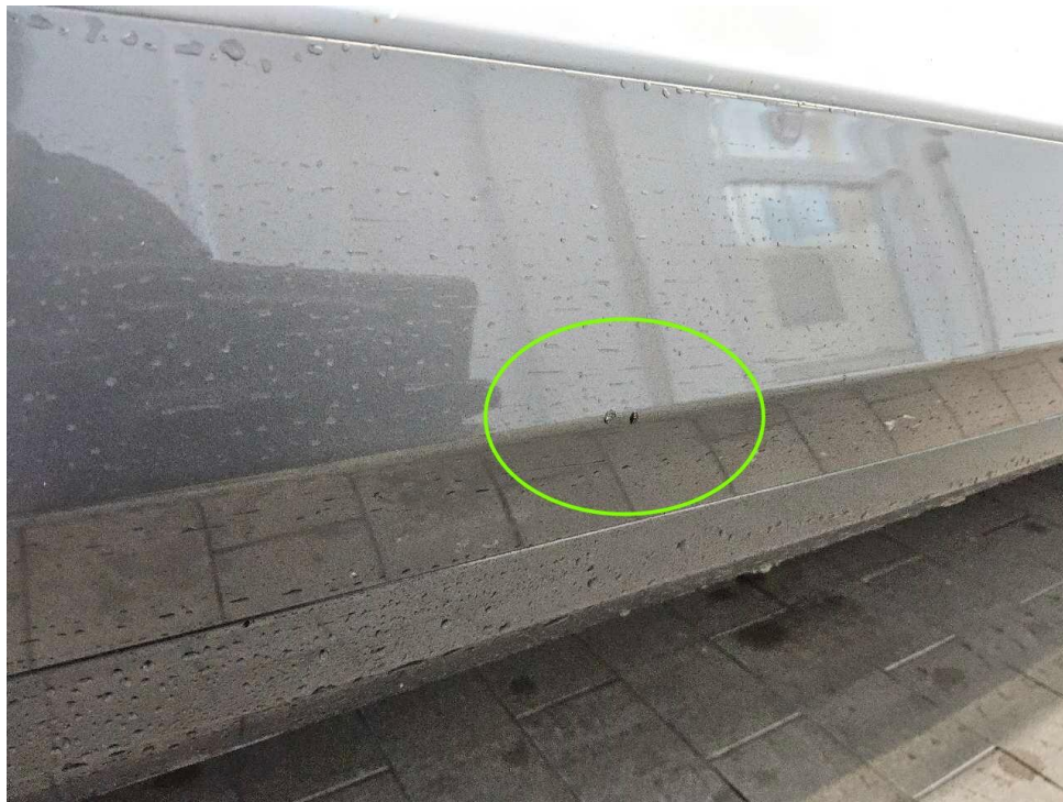
Bild 17 : Tür vorne rechts, Stoßleiste verschrammt
