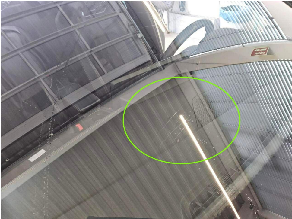
Bild 19 : Frontscheibe, zerkratzt, Gebrauchsspur
