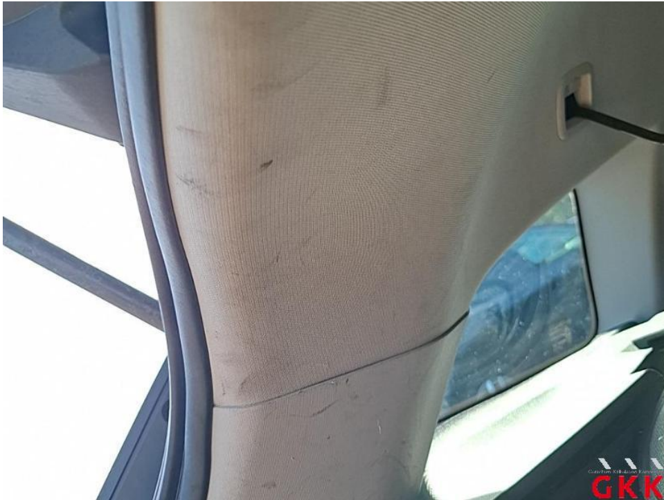
Bild 43. Himmel, beschädigt, ersetzen
