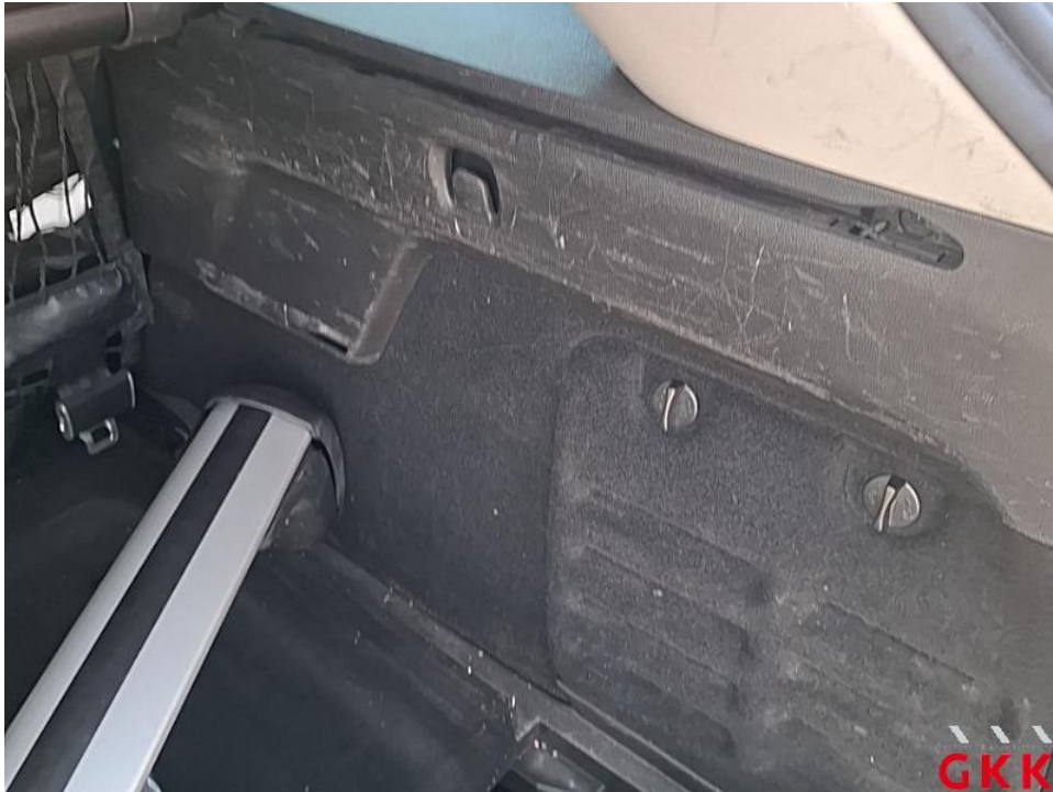
Bild 65. Seitenwand rechts, Innenverkleidung, beschädigt, ersetzen
