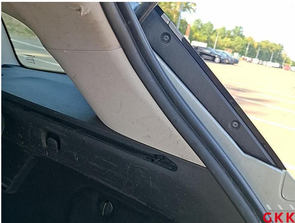
Bild 44. D- Säule rechts, Innenverkleidung, verkratzt, ersetzen
