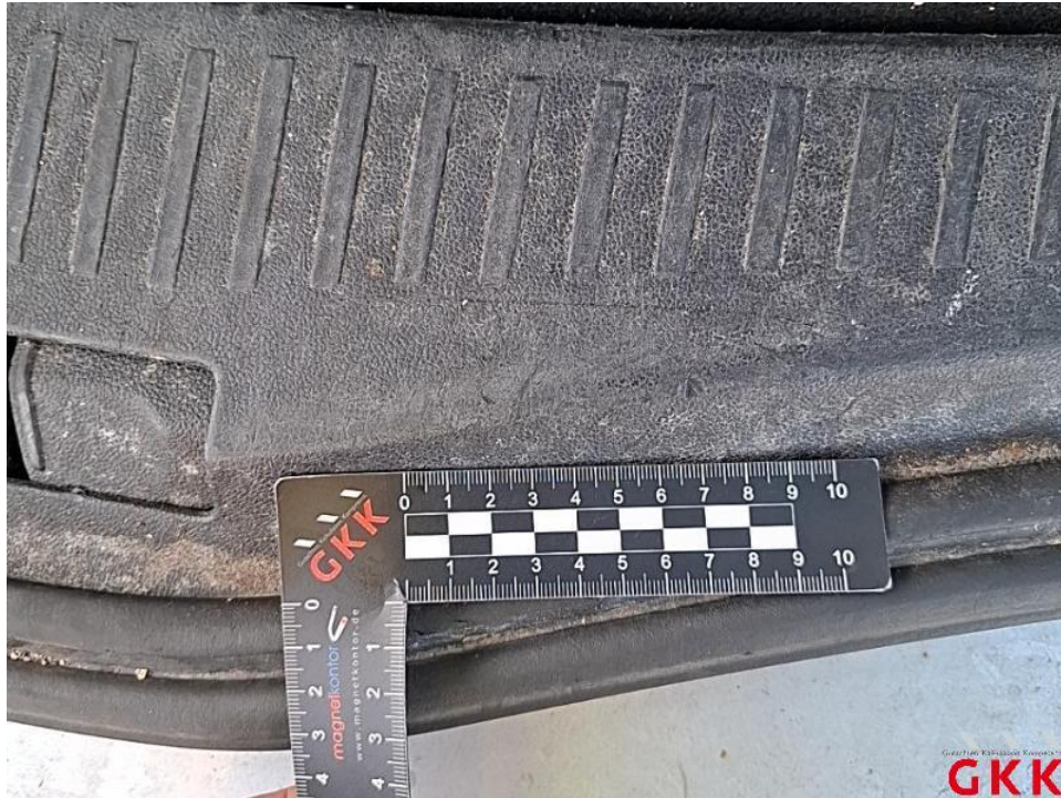
Bild 53. Ladekante, Abdeckung, verkratzt, ersetzen
