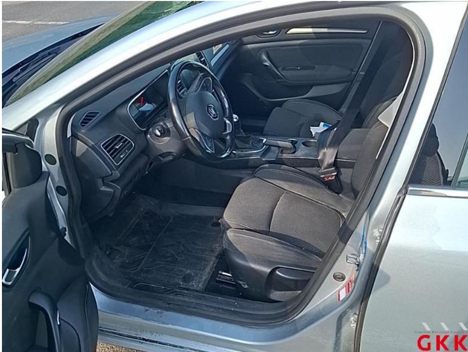
Bild 57. Tür vorne links, Dichtung -Einstieg-, beschädigt, ersetzen
