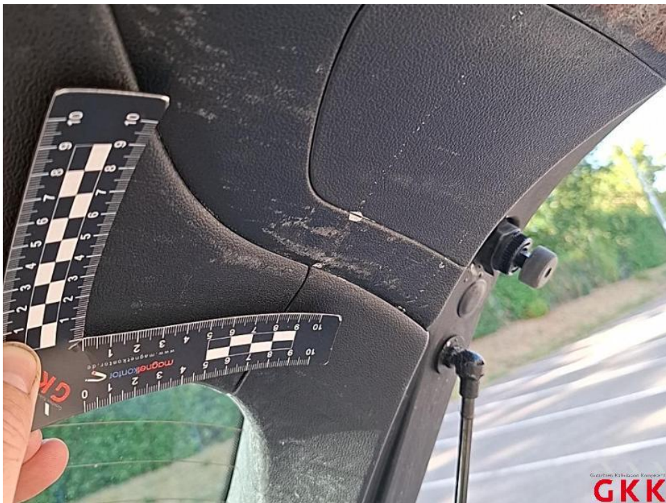
Bild 40. Heckklappe, Innenverkleidung, verkratzt, ersetzen
