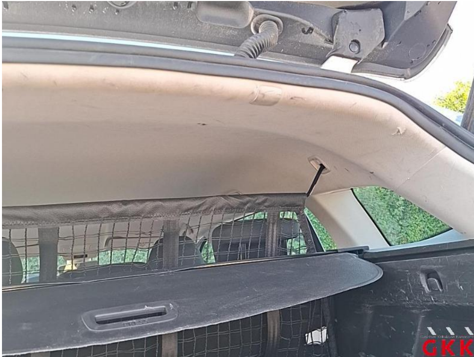
Bild 41. Himmel, beschädigt, ersetzen
