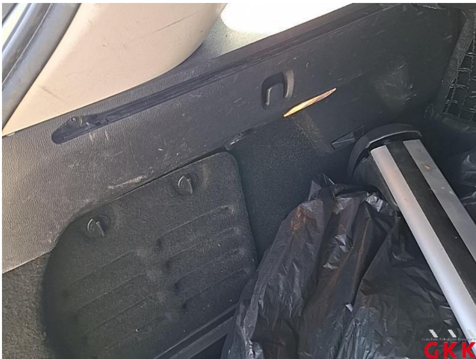
Bild 64. Seitenwand links, Innenverkleidung, beschädigt, ersetzen
