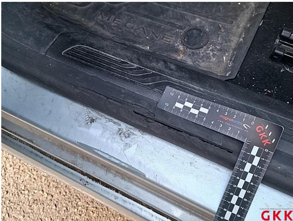
Bild 58. Tür vorne links, Dichtung -Einstieg-, beschädigt, ersetzen
