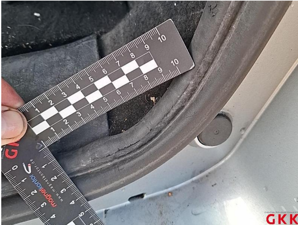
Bild 49. Laderaum, Dichtung, beschädigt, ersetzen
