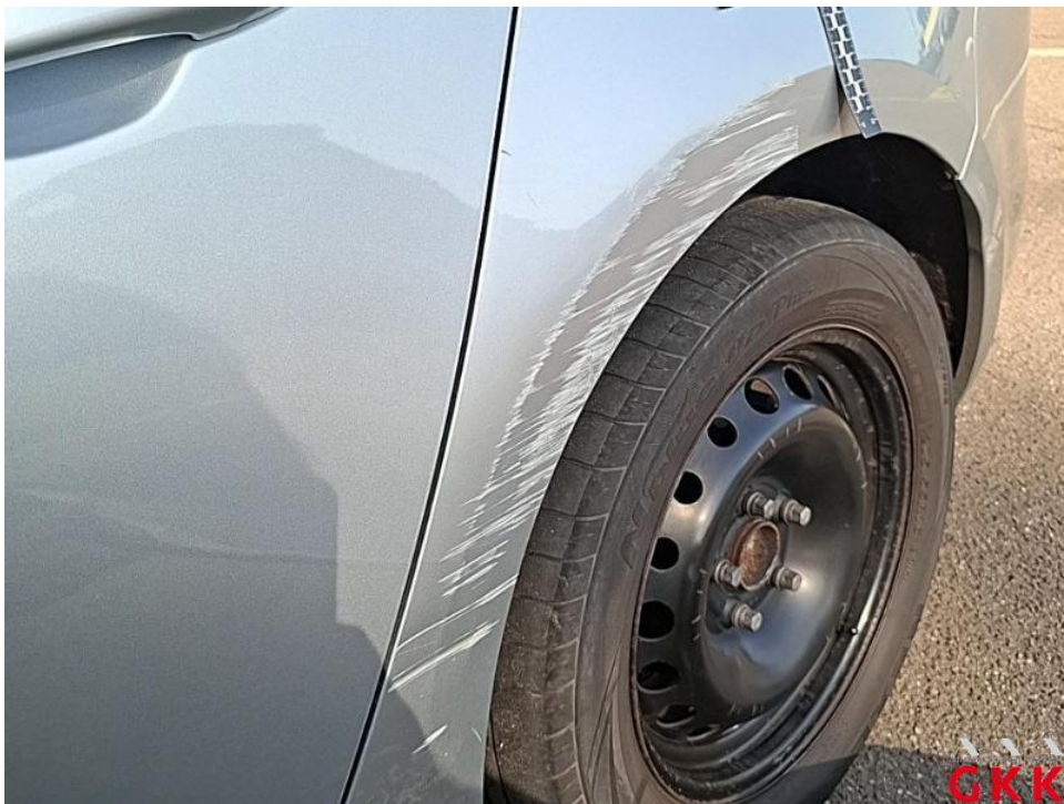
Bild 56. Seitenwand links, beschädigt, instand setzen - lackieren
