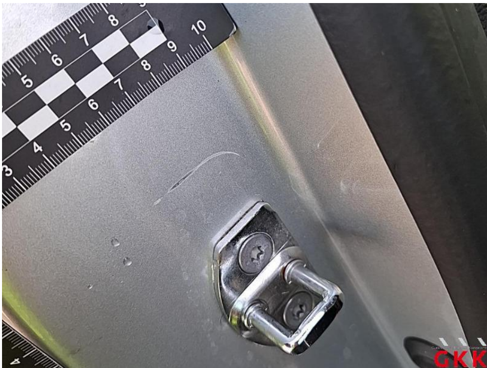
Bild 34. Tür hinten rechts, Einstieg, beschädigt, instand setzen - lackieren
