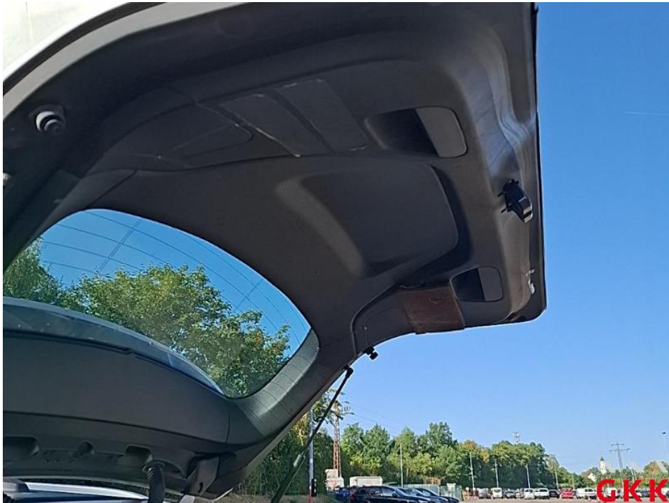
Bild 38. Heckklappe, Innenverkleidung, verkratzt, ersetzen
