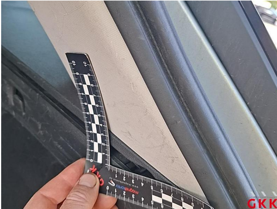
Bild 45. D- Säule rechts, Innenverkleidung, verkratzt, ersetzen
