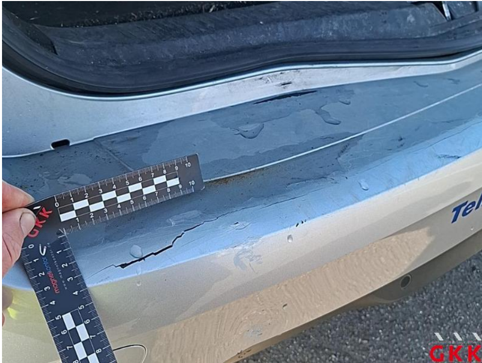
Bild 29. Fahrzeug, Heck, Unfallschaden, instand setzen
