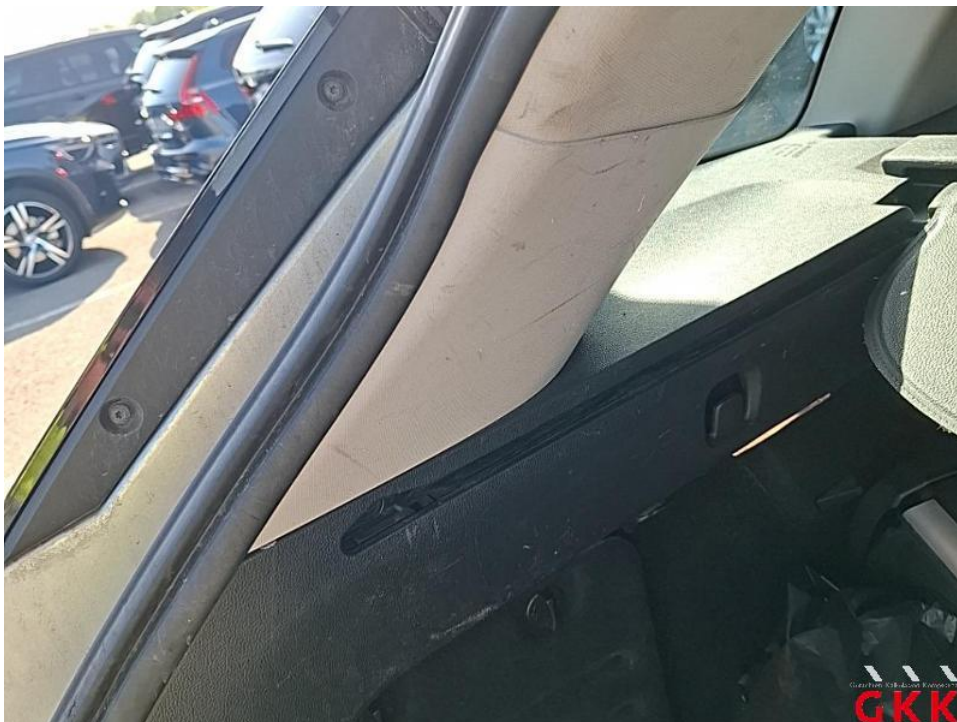
Bild 46. D- Säule links, Innenverkleidung, verkratzt, ersetzen
