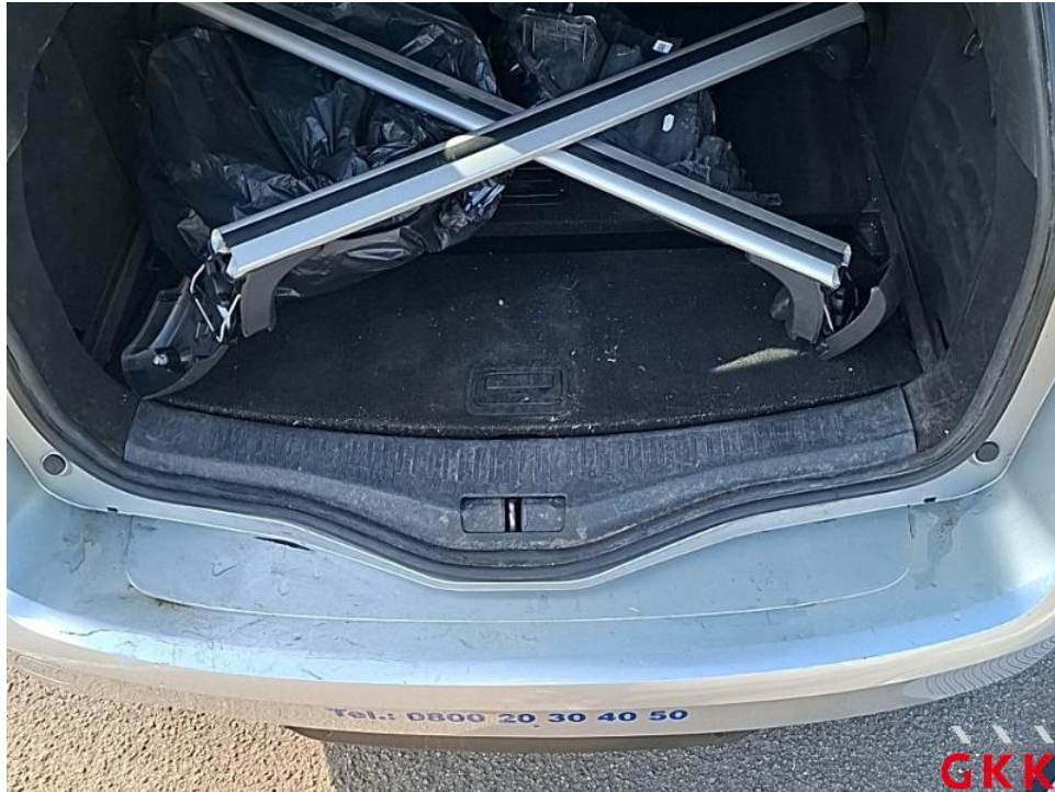
Bild 51. Ladekante, Abdeckung, verkratzt, ersetzen
