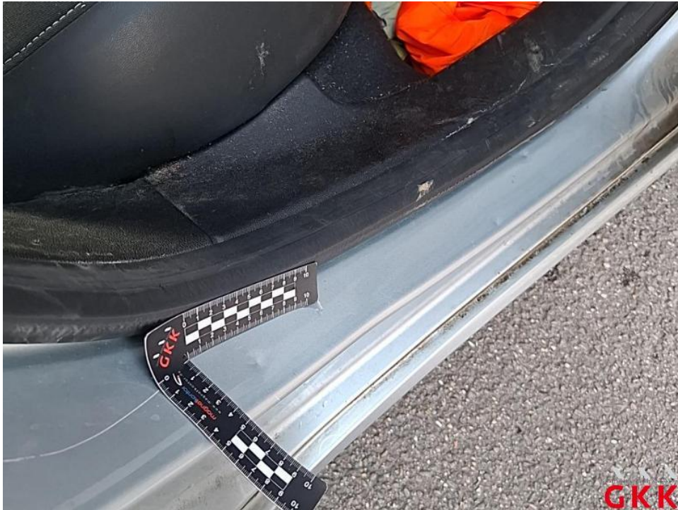
Bild 33. Tür hinten rechts, Einstieg, beschädigt, instand setzen - lackieren
