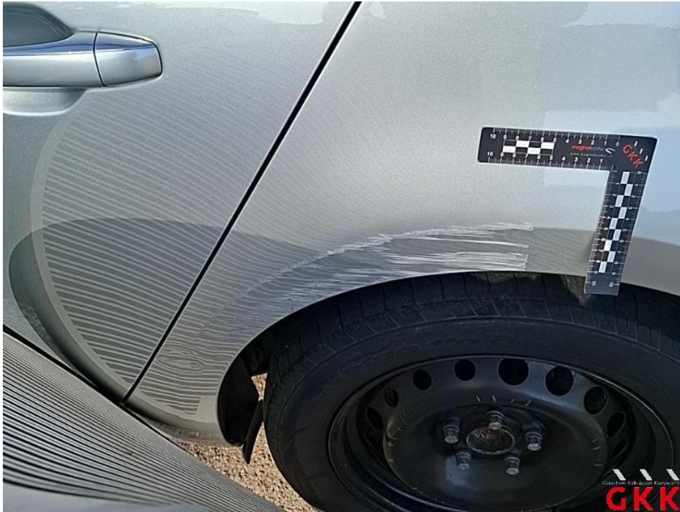
Bild 55. Seitenwand links, beschädigt, instand setzen - lackieren
