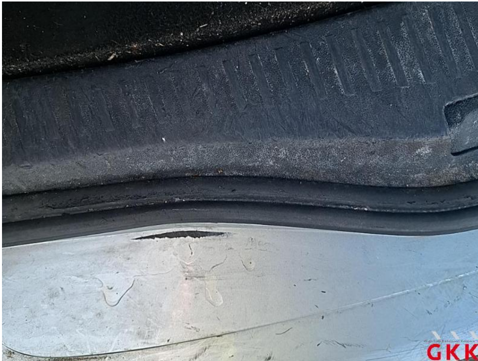
Bild 50. Laderaum, Dichtung, beschädigt, ersetzen
