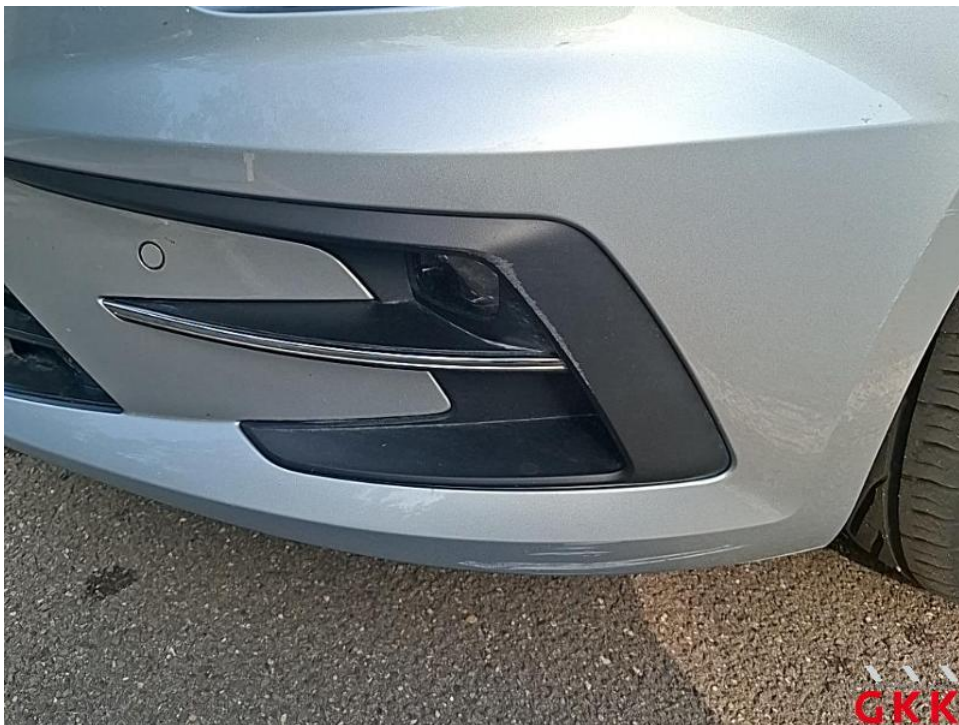
Bild 16. Stoßfänger vorne, Blende -unlackiert-, verkratzt, ersetzen
