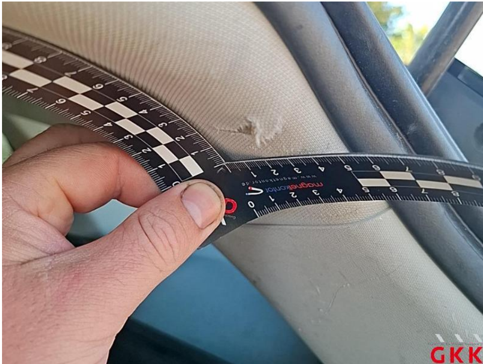
Bild 42. Himmel, beschädigt, ersetzen
