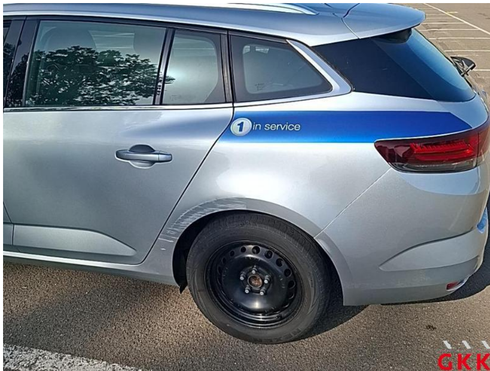
Bild 54. Seitenwand links, beschädigt, instand setzen - lackieren
