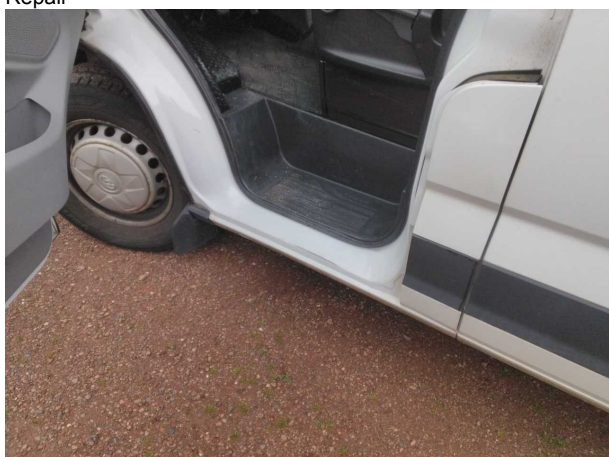
Beschädigung #2: Schweller links: Einstieg - Kratzer - Smart Repair
