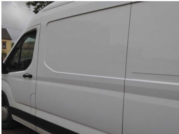
Beschädigung #1: Seitenwand links: Seitenwand - Delle(n) - Smart Repair
