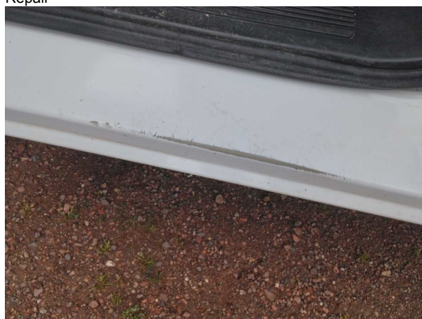
Beschädigung #2: Schweller links: Einstieg - Kratzer - Smart Repair
