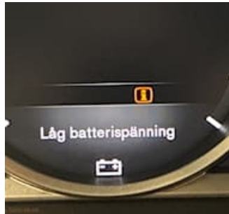
Skadebild Låg batterispänning
