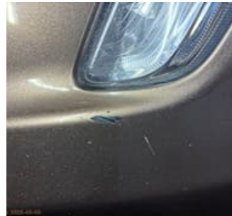
Skadebild Mindre skada stötfångare fram
