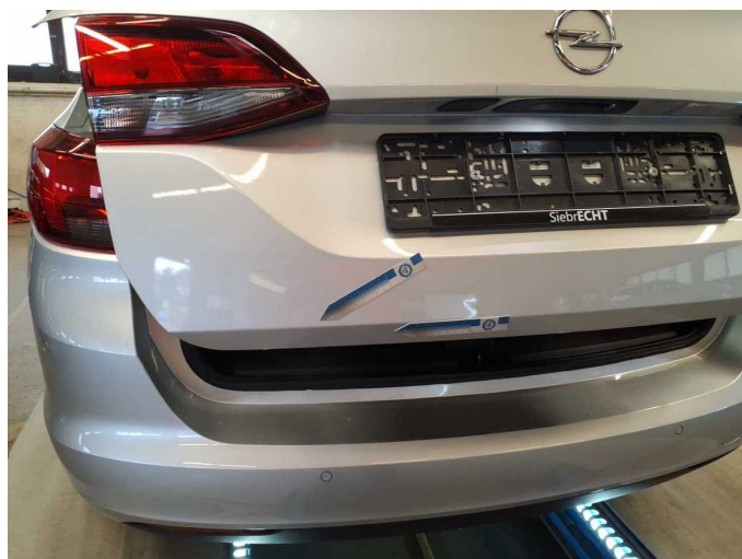
Damage 16: Boot lid / rear door: Boot lid - Scratch(es) - Paint
