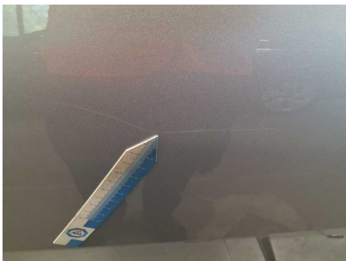
Damage 15: Door - rear left side: Door - Scratch(es) - Paint
