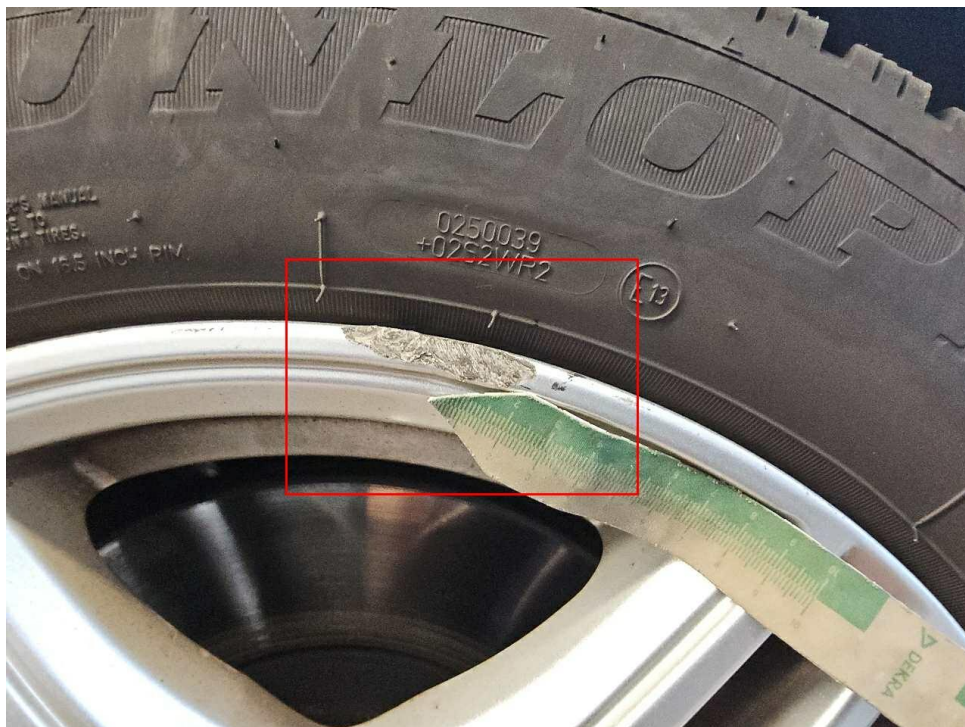
Bild 32 : Alufelge vorne rechts, verschrammt, erneuern
