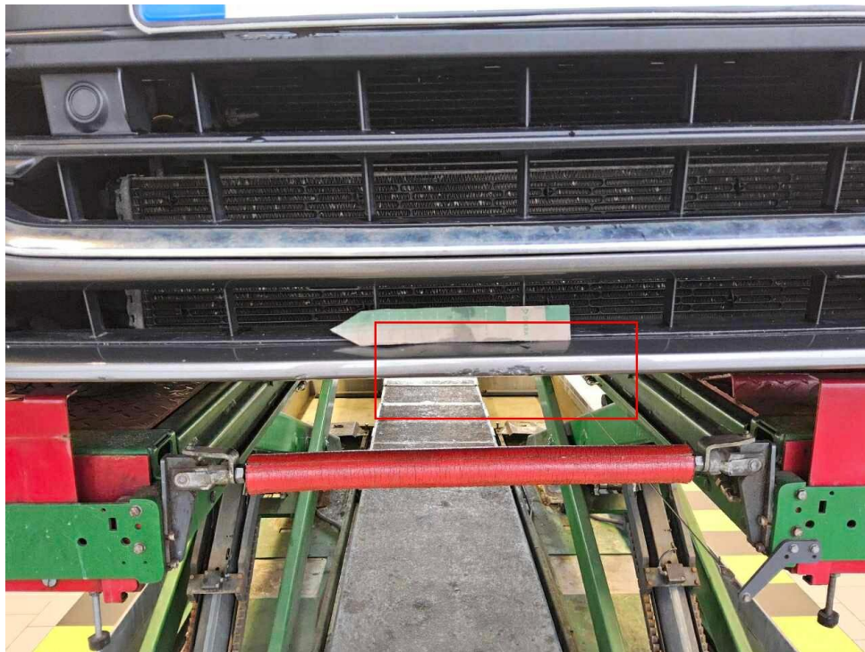
Bild 27 : Stoßfänger vorne, verschrammt, lackieren
