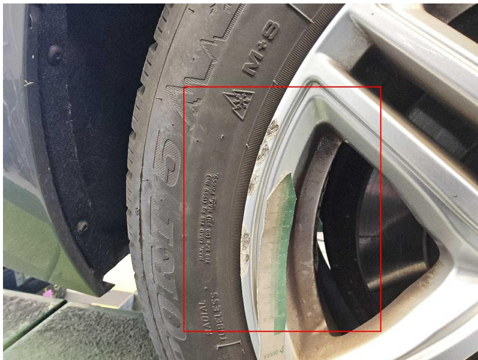
Bild 34 : Alufelge hinten rechts, verschrammt, erneuern
