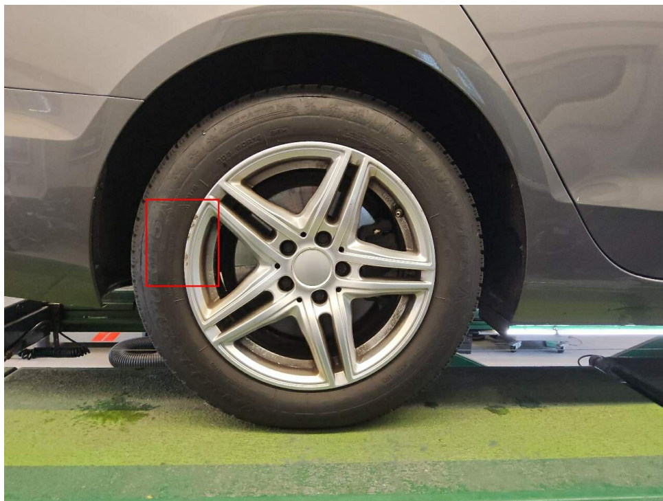
Bild 33 : Alufelge hinten rechts, verschrammt, erneuern
