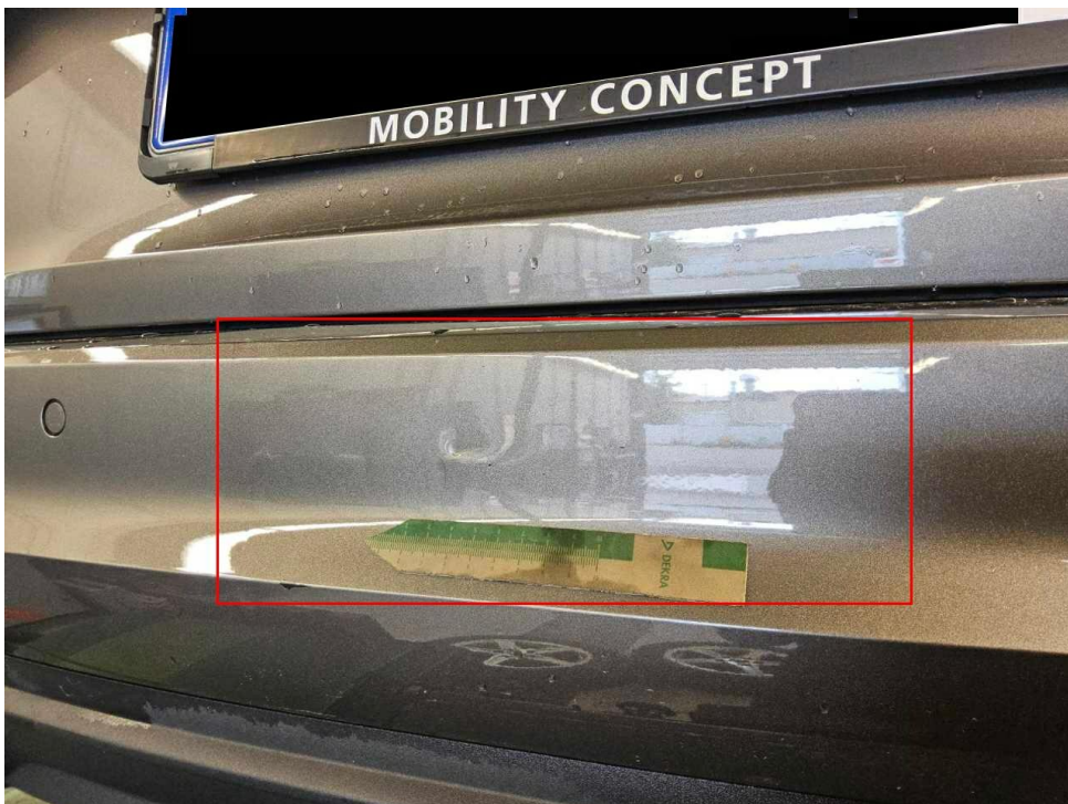
Bild 18 : Stoßfänger hinten, deformiert, erneuern
