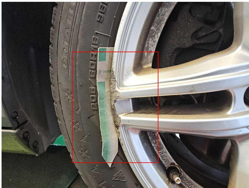
Bild 31 : Alufelge vorne rechts, verschrammt, erneuern
