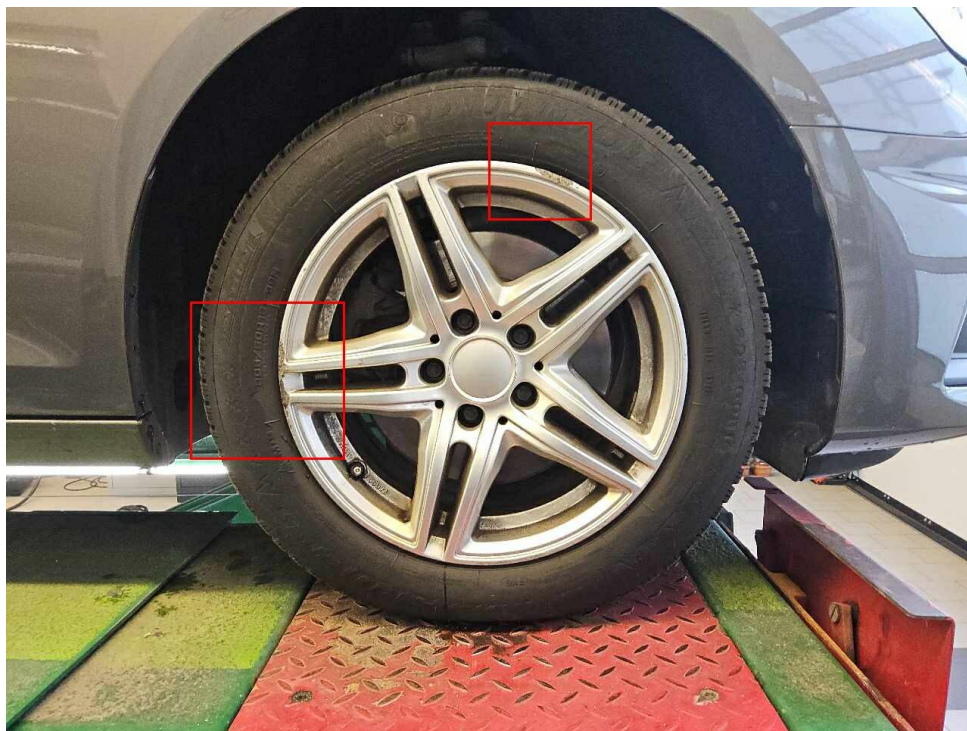
Bild 30 : Alufelge vorne rechts, verschrammt, erneuern
