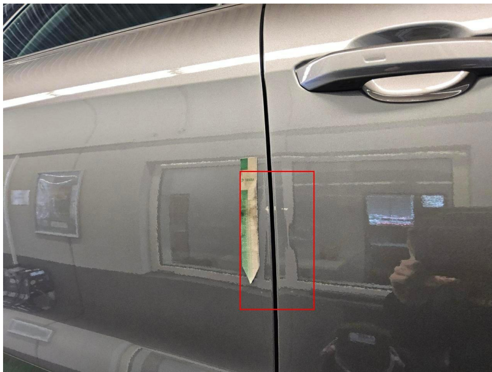
Bild 23 : Tür vorne rechts, deformiert, instandsetzen und lackieren mit Lackaufbau
