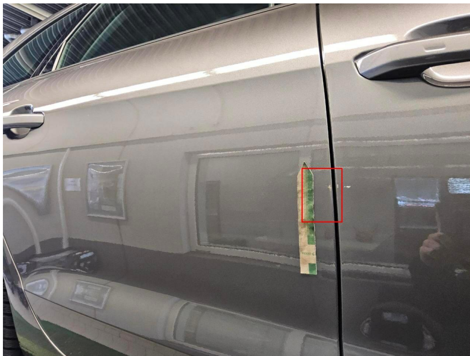
Bild 20 : Tür hinten rechts Lackierung, verschrammt, lackieren
