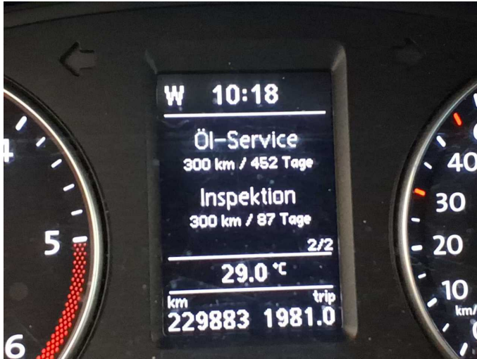
Damage 1: Misc.: Inspection / maintenance (Motorölservice/Inspektion fällig in 300km Restreichweite) - No evidence - No deduction
