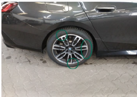
Felge / Hinten Rechts / Abgewetzt
