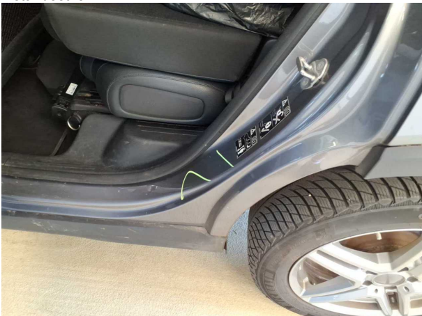
Beschädigung #5: Seitenwand links: Einstieg - Delle / Lackschaden - Smart Repair
