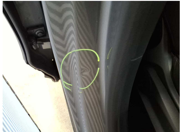
Beschädigung #4: Schweller rechts: Einstieg - Delle(n) - sanft instandsetzen
