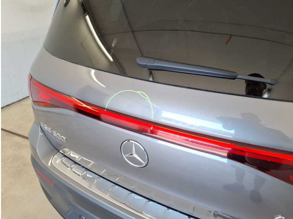
Beschädigung #3: Heckklappe/-tür: Heckklappe - Delle(n) - sanft instandsetzen
