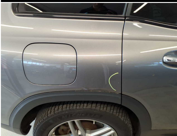
Beschädigung #6: Seitenwand rechts: Seitenwand - verkratzt / verschürft - Smart Repair
