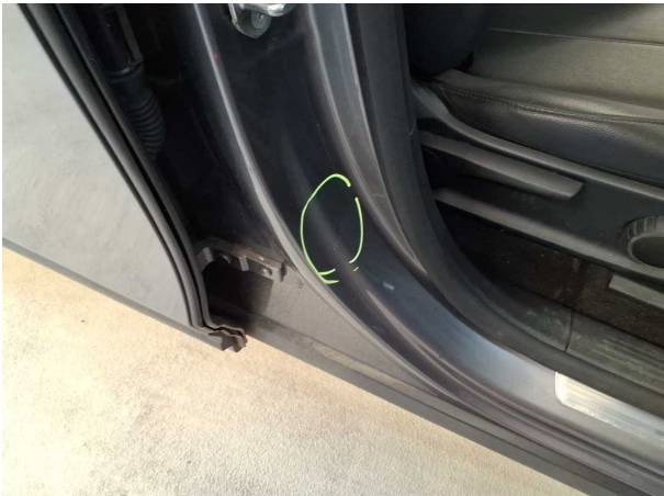
Beschädigung #4: Schweller rechts: Einstieg - Delle(n) - sanft instandsetzen
