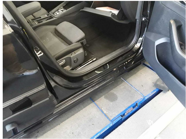
Beschädigung #5: Schweller rechts: Einstieg - Delle(n) - sanft instandsetzen
