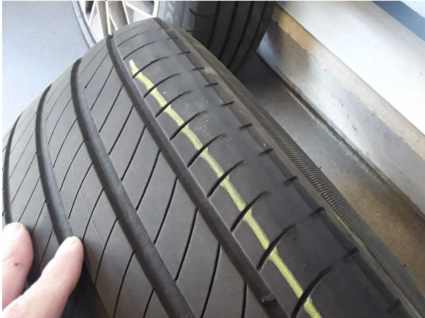
Beschädigung #3: Vorderachse: Achsen / Fahrwerk - Fehlstellung - vermessen
