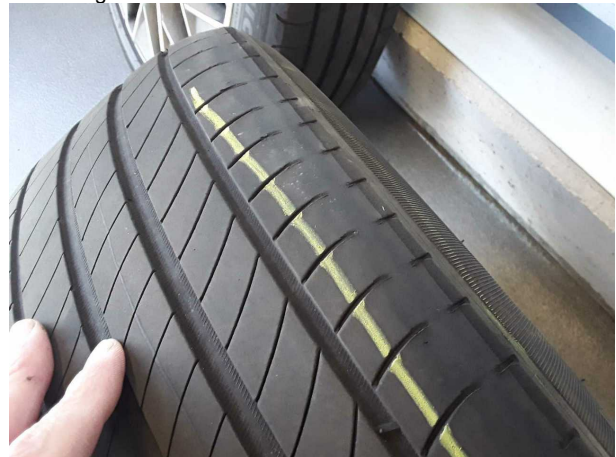
Beschädigung #6: 2.Radsatz: 2 Reifen (Einseitig abefahren) - beschädigt - erneuern
