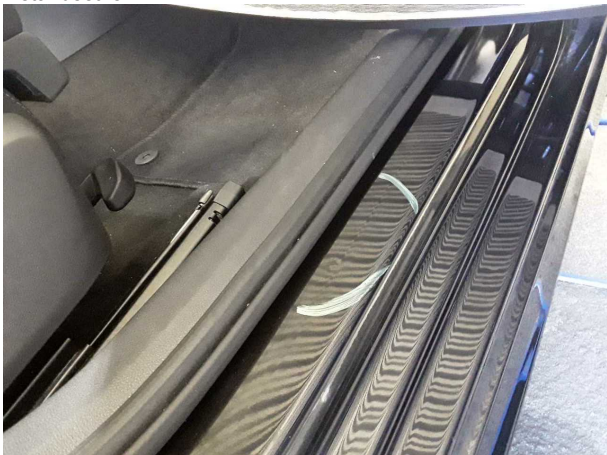
Beschädigung #5: Schweller rechts: Einstieg - Delle(n) - sanft instandsetzen
