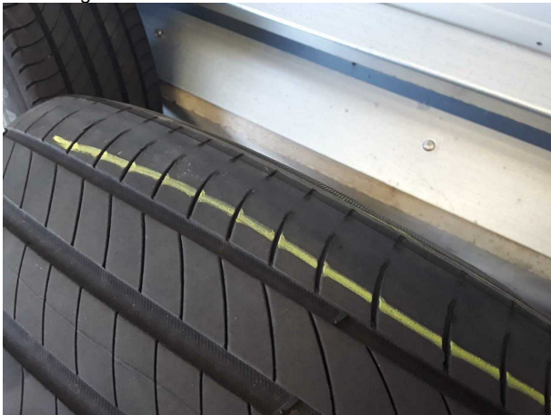
Beschädigung #6: 2.Radsatz: 2 Reifen (Einseitig abefahren) - beschädigt - erneuern
