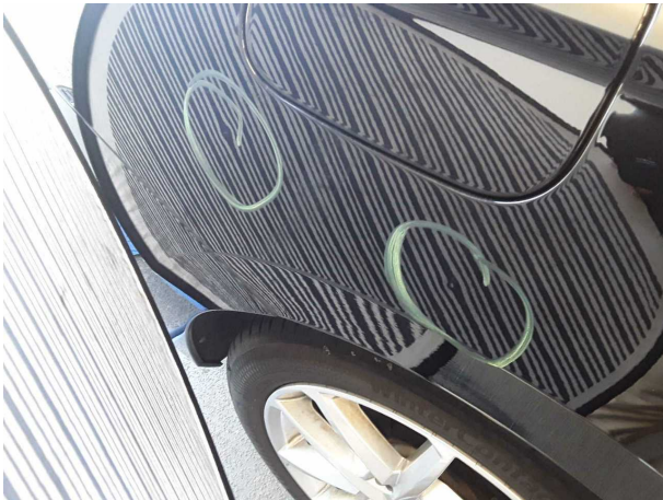
Beschädigung #14: Seitenwand rechts: Seitenwand - Delle / Lackschaden - instandsetzen und lackieren
