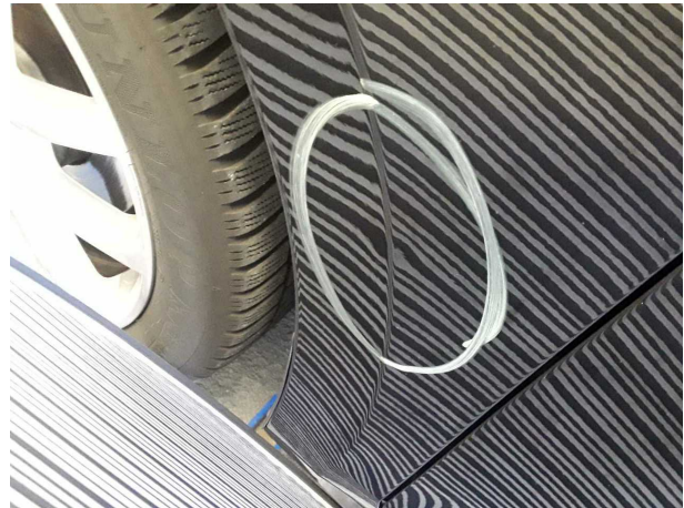
Beschädigung #4: Kotflügel links: Kotflügel links - Delle(n) - sanft instandsetzen
