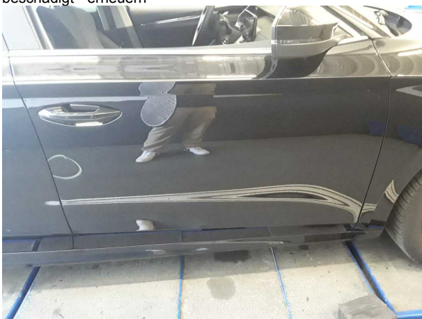
Beschädigung #11: Tür vorn rechts: Tür - Kratzer - lackieren
