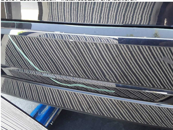
Beschädigung #12: Stossfänger hinten: Stossfänger hinten - Delle / Lackschaden - instandsetzen und lackieren
