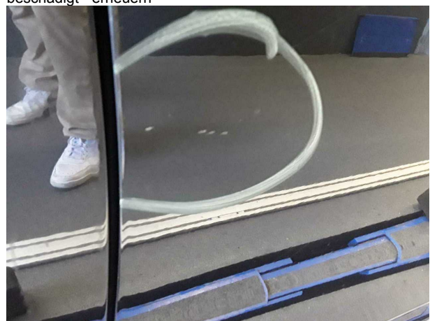
Beschädigung #11: Tür vorn rechts: Tür - Kratzer - lackieren
