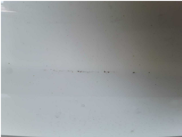
Beschädigung #4: Heckklappe/-tür: Heckklappe - verkratzt / verschürft - lackieren
