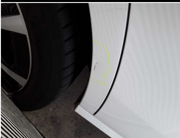
Beschädigung #3: Seitenwand rechts: Seitenwand - Delle / Lackschaden - instandsetzen und lackieren
