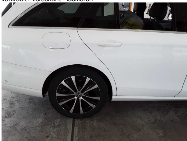
Beschädigung #3: Seitenwand rechts: Seitenwand - Delle / Lackschaden - instandsetzen und lackieren
