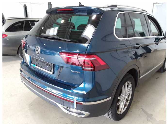
Damage 5: Rear bumper: Rear bumper (Inkl Spoiler und Zierleiste erneuern) - Deformed - Replace
