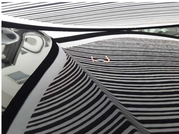
Beschädigung #2: Motorhaube: Motorhaube - Delle / Lackschaden - Smart Repair
