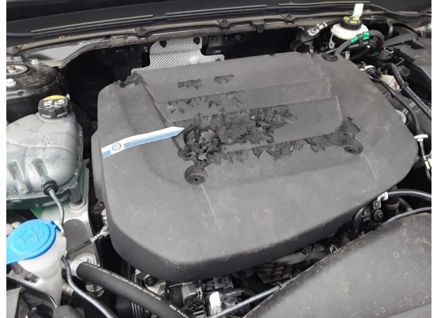
Beschädigung #1: Motor: Motorabdeckung - beschädigt - erneuern
