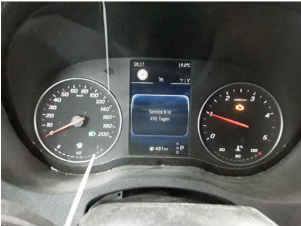
Beschädigung #3: Instrumententafel: Kontrollleuchte (Motorkontrolle...) leuchtet - Diagnose durchführen
