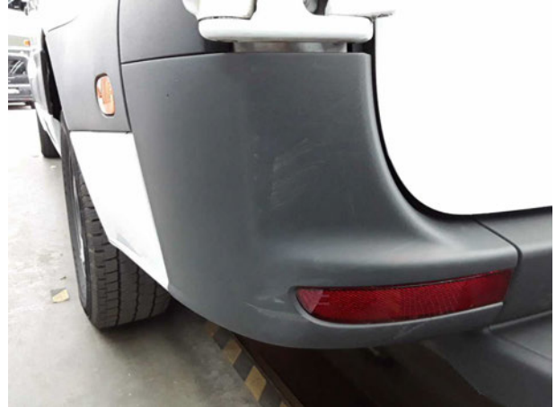
Beschädigung #2: Stossfänger hinten: Stossfänger hinten links - verkratzt / verschürft - erneuern
