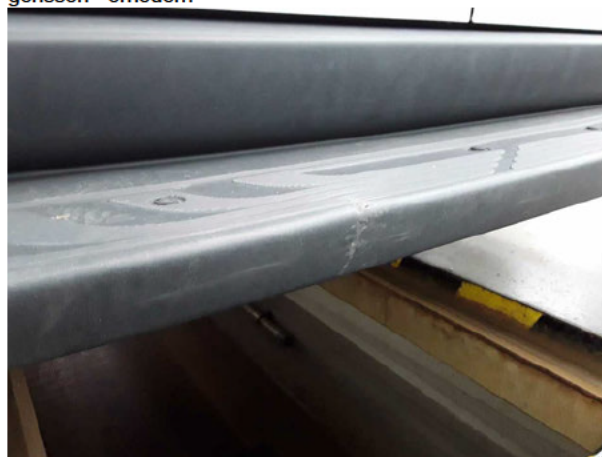
Beschädigung #10: Stossfänger hinten: Verkl. Stossfänger Auftritt mit Parktronic - verformt - erneuern
