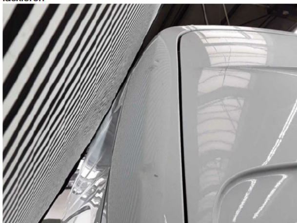
Beschädigung #9: Karosserie: Eckbeplankung links - Delle / Lackschaden - instandsetzen und lackieren
