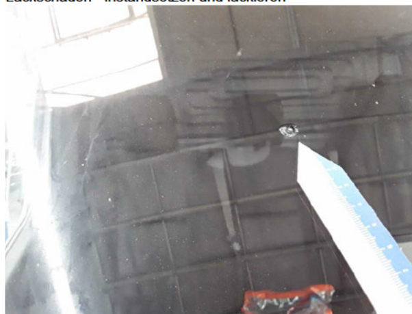
Beschädigung #12: Verglasung: Frontscheibe mit Spurhalteassistent - Steinschlag - erneuern
