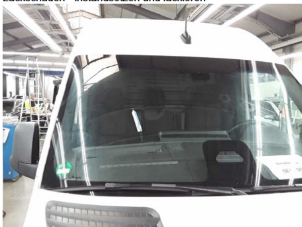
Beschädigung #12: Verglasung: Frontscheibe mit Spurhalteassistent - Steinschlag - erneuern
