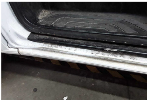
Beschädigung #7: Schweller links: Einstieg - verkratzt / verschürft - lackieren
