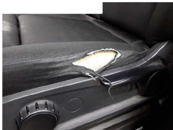
Beschädigung #8: Sitz vorn: Sitzbezug links - gebrochen / gerissen - erneuern
