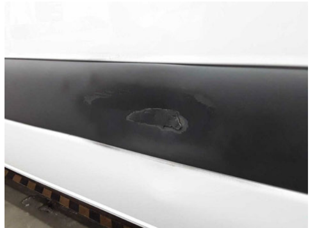
Beschädigung #4: Seitenwand links: Schutzleiste - gebrochen / gerissen - erneuern
