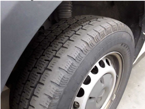
Beschädigung #5: Festpreis: Reifen 235/65 R16C (VL) - verschlisse... erneuern
