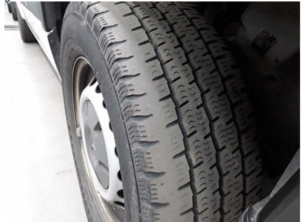
Beschädigung #6: Festpreis: Reifen 235/65 R16C (VR) - verschlissen - erneuern
