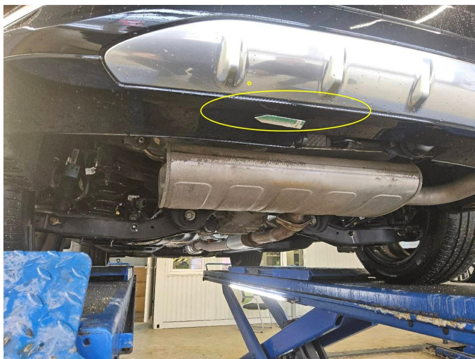
Bild 20 : Stoßfänger hinten, Unterteil zerkratzt
