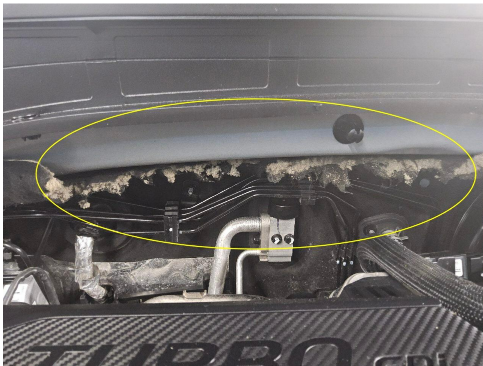
Bild 16 : Stirnwand, Dämmmatte zerrissen
