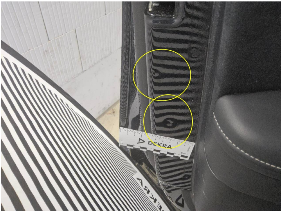
Bild 18 : Türrahmen vorne links eingedellt
