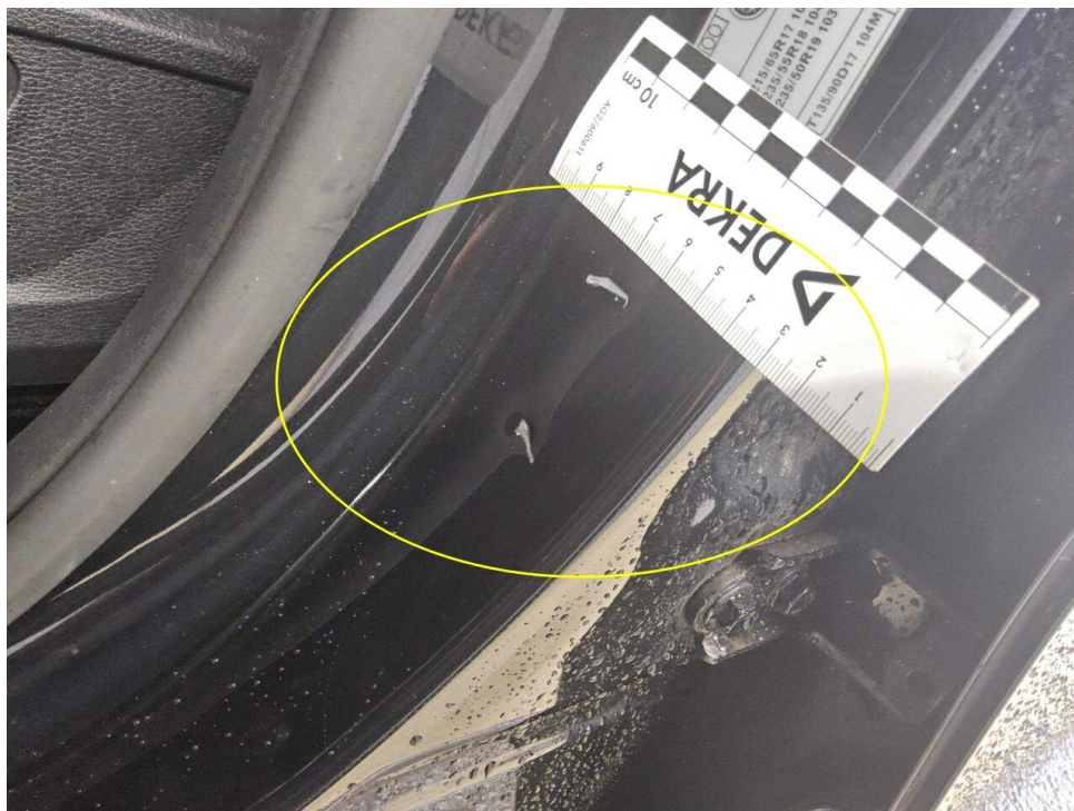
Bild 9 : Tür vorne links Einstieg, verschrammt, smart repair
