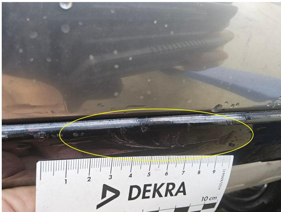
Bild 21 : Stoßfänger hinten, Unterteil zerkratzt
