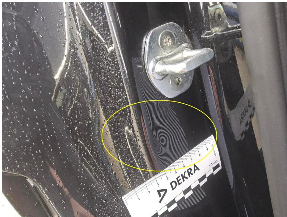
Bild 15 : Tür hinten rechts Einstieg, eingedellt, drücken
