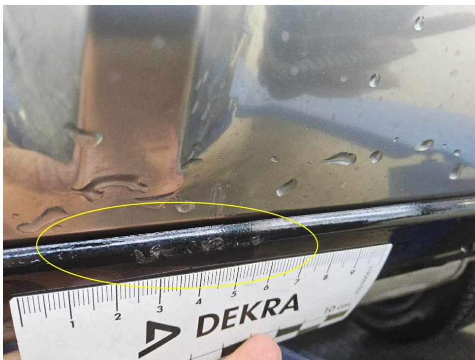
Bild 22 : Stoßfänger hinten, Unterteil zerkratzt
