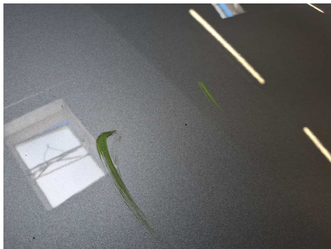
Damage 14: Bonnet: Bonnet (Sandstrahleffekt) - Stone chips - Paint
