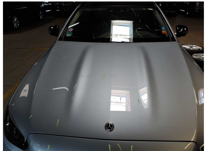
Damage 14: Bonnet: Bonnet (Sandstrahleffekt) - Stone chips - Paint
