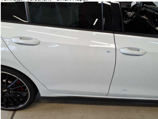
Beschädigung #9: Tür hinten rechts: Tür - verkratzt / verschürft - instandsetzen und lackieren
