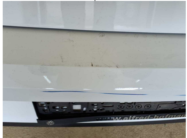
Beschädigung #8: Stossfänger hinten: Stossfänger hinten - verkratzt / verschürft - Smart Repair
