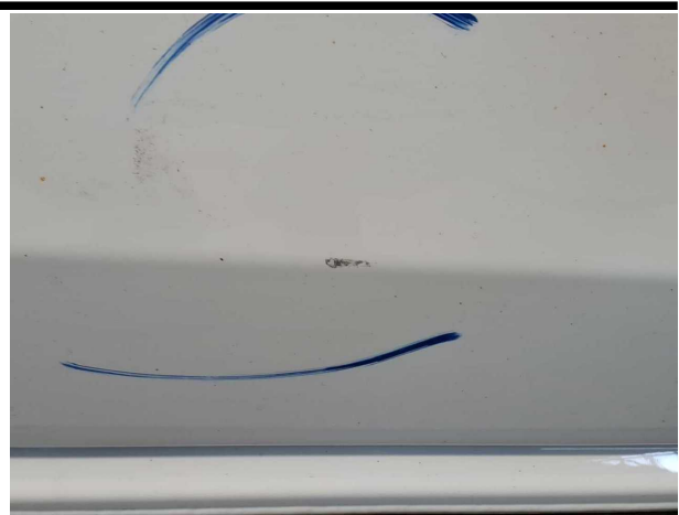
Beschädigung #10: Tür vorn rechts: Tür - verkratzt / verschü... - instandsetzen und lackieren
