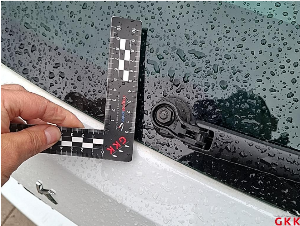
Bild 13. Heckwischer, Abdeckung, fehlt, ersetzen
