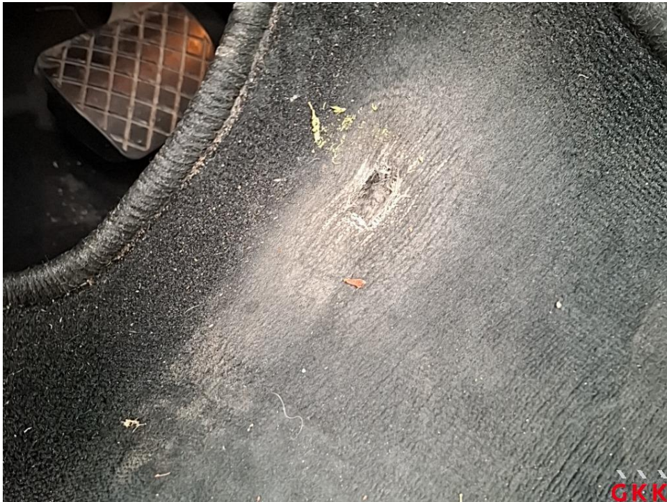
Bild 18. Fußmatte(n), vorne links, beschädigt, ersetzen
