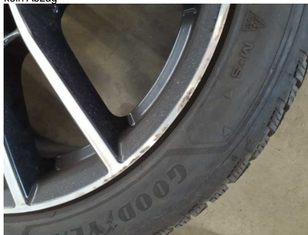
Beschädigung #3: 2.Radsatz: 1 Leichtmetallfelge - Kratzer - kein Abzug
