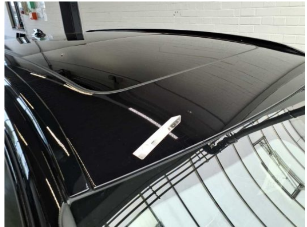
Beschädigung #13: Fahrzeugdach: Dach - Korrosion - instandsetzen und lackieren
