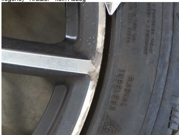
Beschädigung #3: 2.Radsatz: 1 Leichtmetallfelge - Kratzer - kein Abzug
