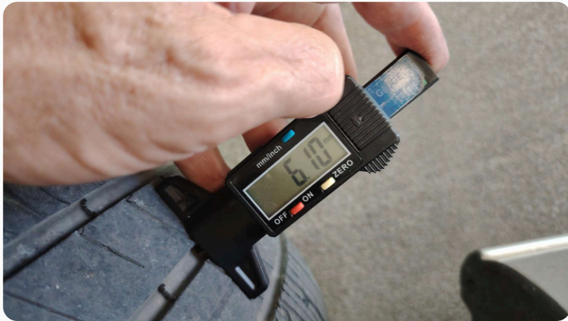
Photo mesure usure pneu avant droit
