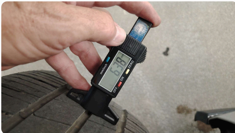
Photo mesure usure pneu avant gauche
