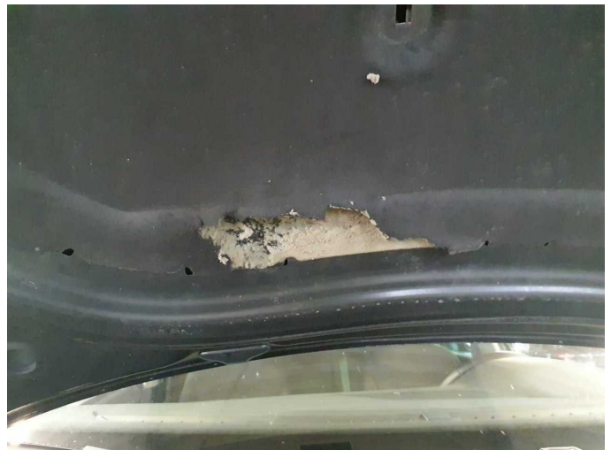
Damage 1: Bonnet: Insulation lining (de-/ montage bei Lackierung der Haube bereits berechnet) - Damage caused by marten / rodent - Replace
