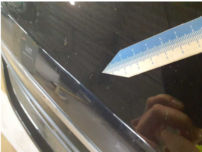
Damage 3: Bonnet: Bonnet (Teilweise schon ausgepinselt) - Stone chips - Paint
