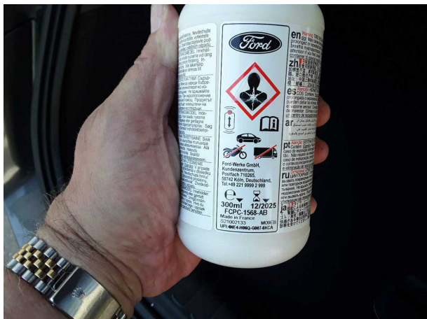
Beschädigung #1: Ausrüstung: Tirefit Füllmittel - abgelaufen - erneuern
