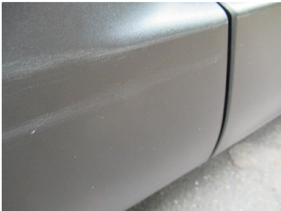
Bild 40 : Tür hinten rechts: untere Blende / Radlaufblende Kratzer
