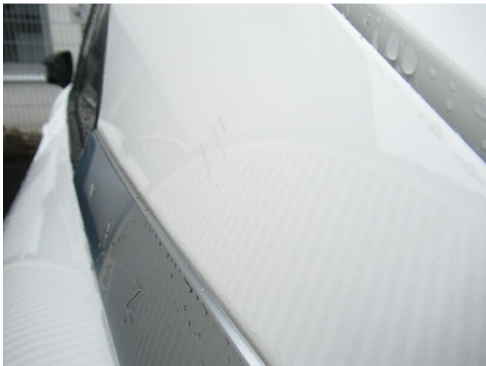
Bild 32 : Dachrahmen links Lackierung, zerkratzt, lackieren mit Lackaufbau
