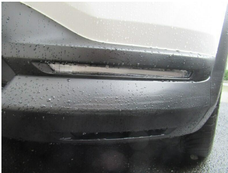
Bild 24 : Stoßfänger vorne Spoilerleiste und Radlaufblende vorne links verschrammt.
