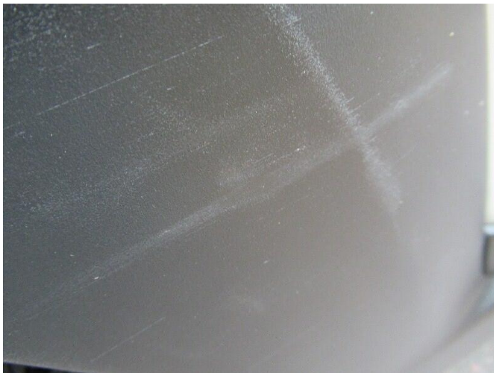
Bild 39 : Tür hinten rechts: untere Blende / Radlaufblende Kratzer
