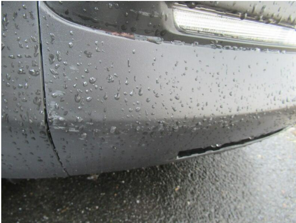
Bild 27 : Stoßfänger vorne Spoilerleiste und Radlaufblende vorne links verschrammt.
