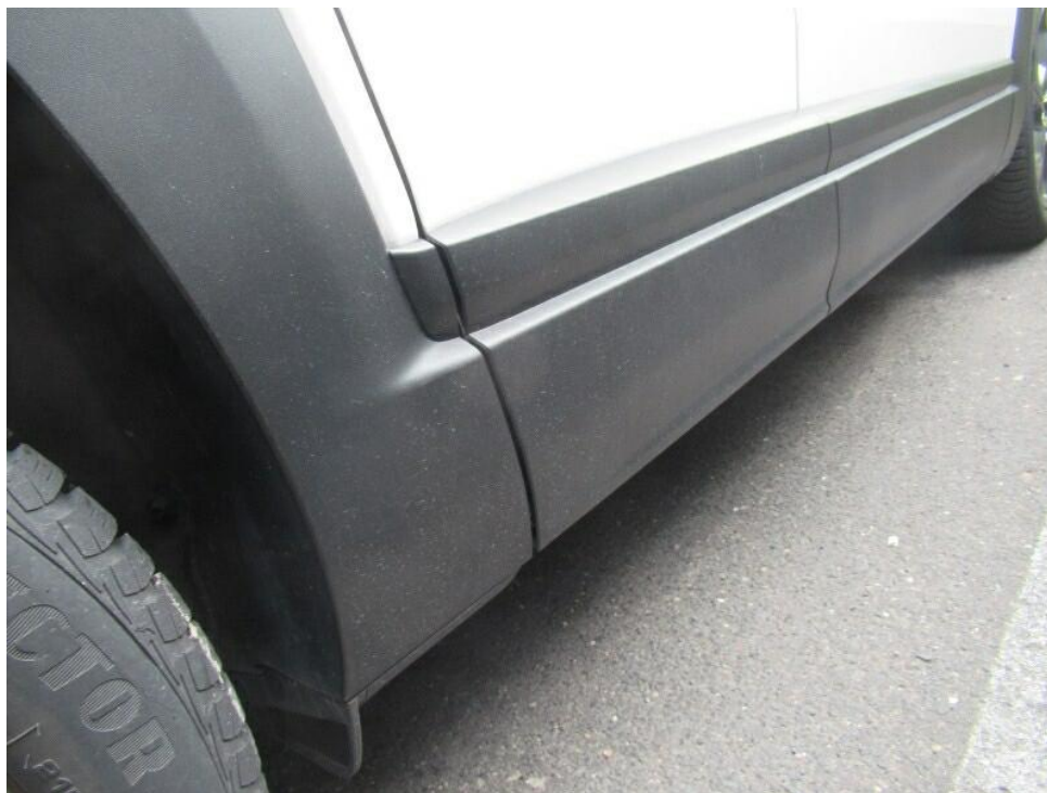
Bild 38 : Tür hinten rechts: untere Blende / Radlaufblende Kratzer
