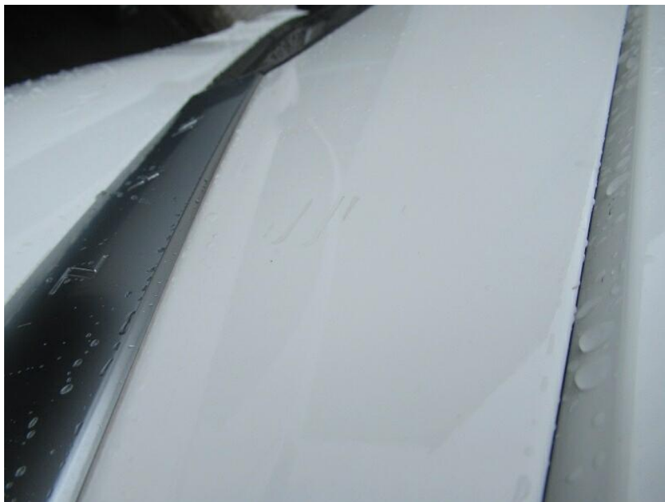
Bild 33 : Dachrahmen links Lackierung, zerkratzt, lackieren mit Lackaufbau
