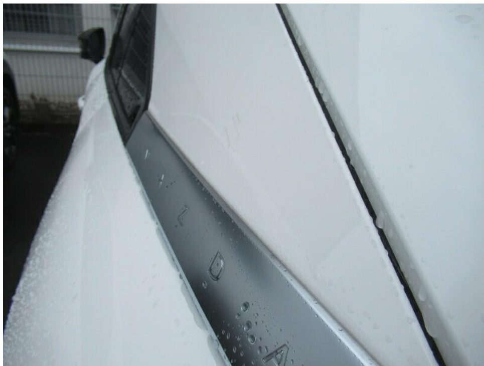
Bild 31 : Dachrahmen links Lackierung, zerkratzt, lackieren mit Lackaufbau
