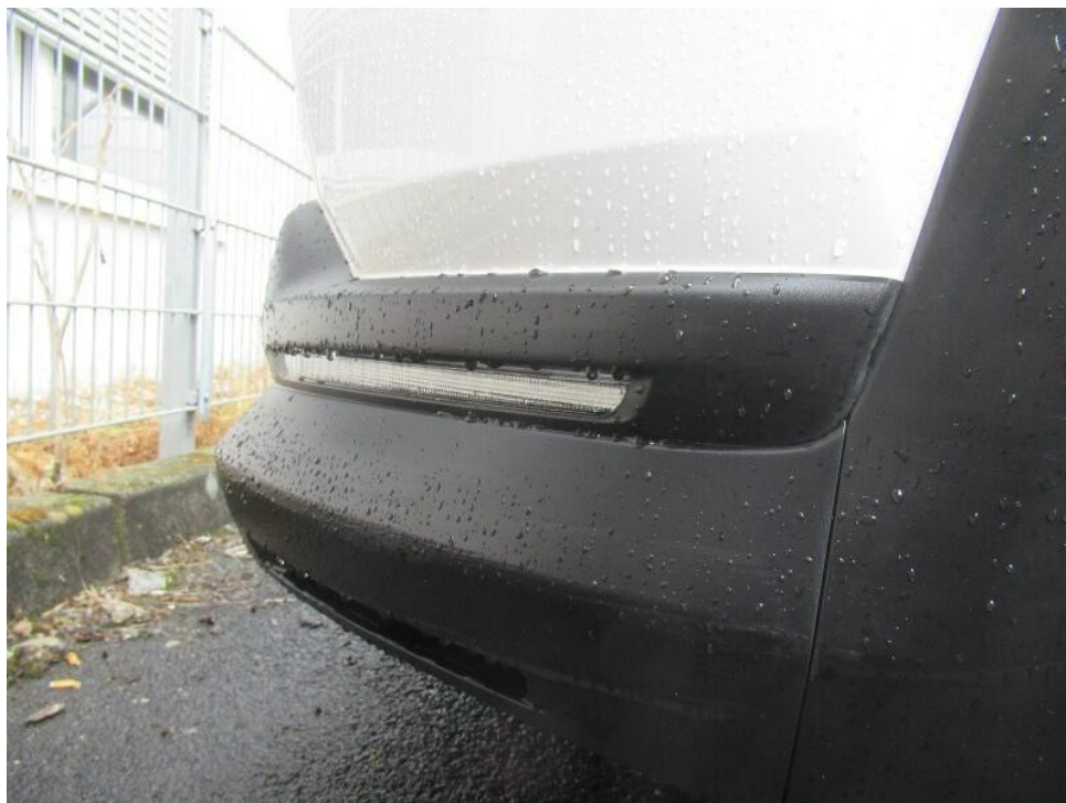
Bild 26 : Stoßfänger vorne Spoilerleiste und Radlaufblende vorne links verschrammt.
