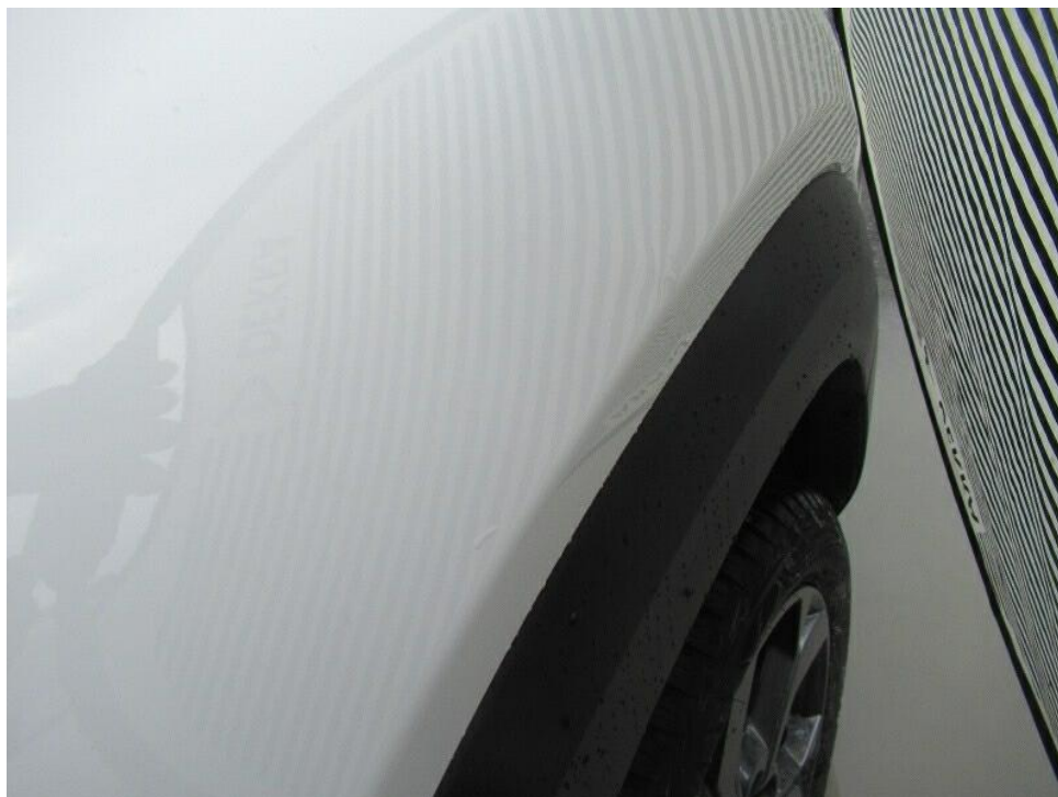
Bild 30 : Seitenteil hinten links, eingedellt, drücken
