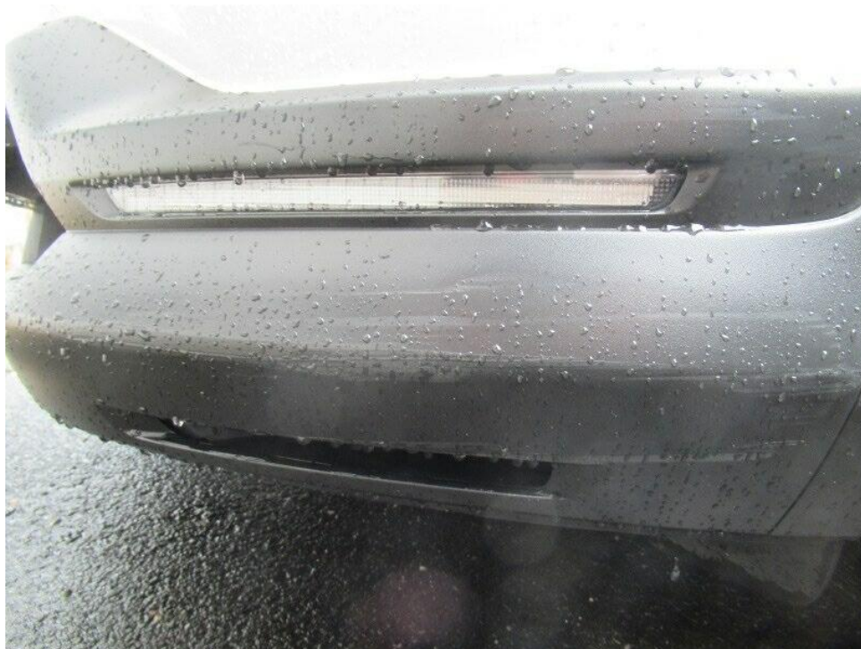
Bild 25 : Stoßfänger vorne Spoilerleiste und Radlaufblende vorne links verschrammt.
