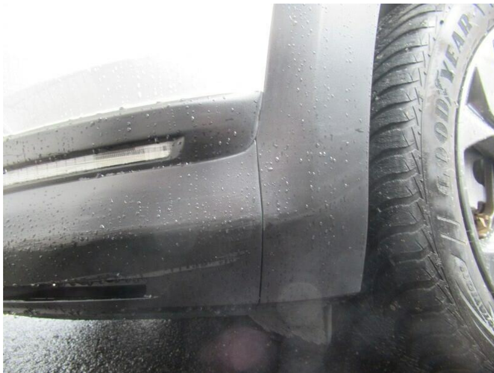
Bild 23 : Stoßfänger vorne Spoilerleiste und Radlaufblende vorne links verschrammt.
