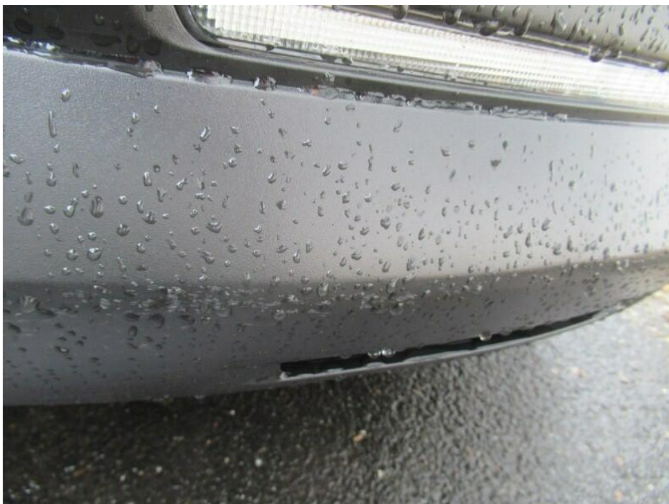
Bild 28 : Stoßfänger vorne Spoilerleiste und Radlaufblende vorne links verschrammt.
