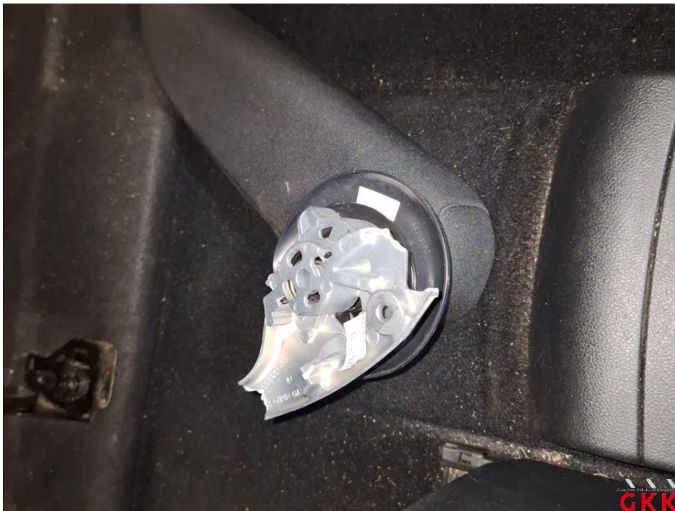
Bild 18 Armlehne, vorne rechts, beschädigt, ersetzen
