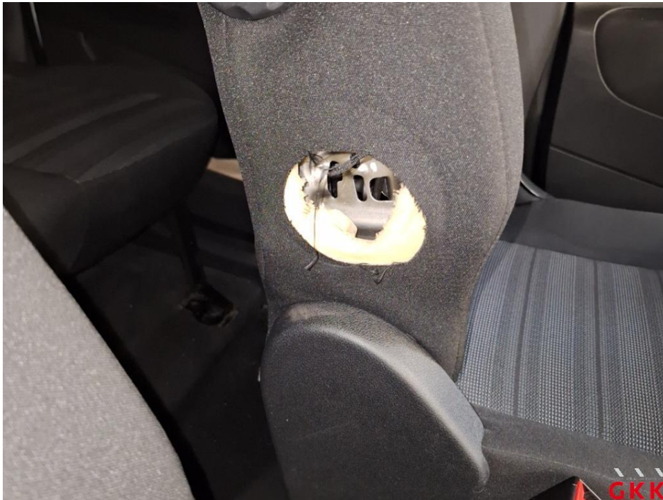
Bild 17 Armlehne, vorne rechts, beschädigt, ersetzen
