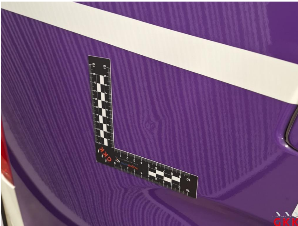
Bild 20 Seitenwand rechts, beschädigt, kalt drücken
