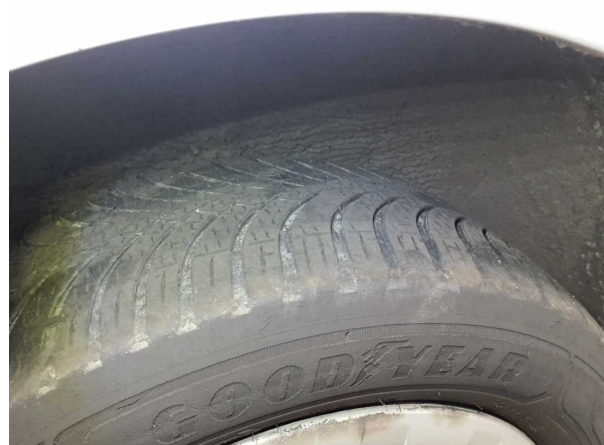
Beschädigung #11: Rad/Reifen: Reifen hinten rechts - verschlissen - erneuern
