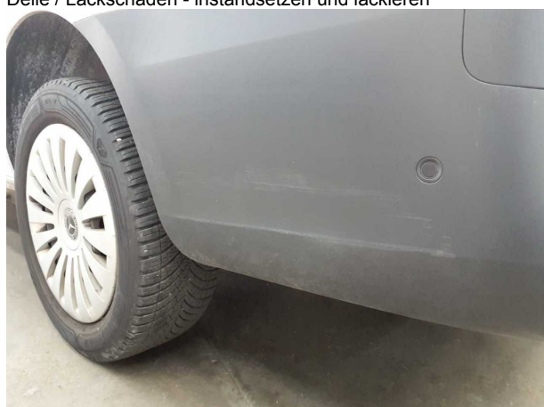
Beschädigung #16: Stossfänger hinten: Stossfänger mit Parktronic - verkrazt / verschürft - erneuern
