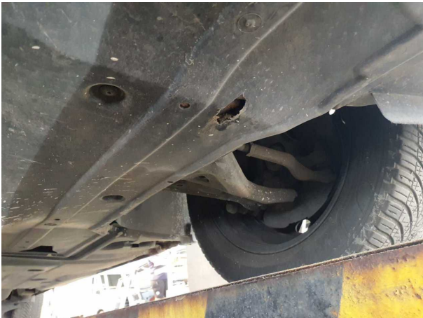
Beschädigung #21: Vorderachse: Achsträger - verformt - erneuern
