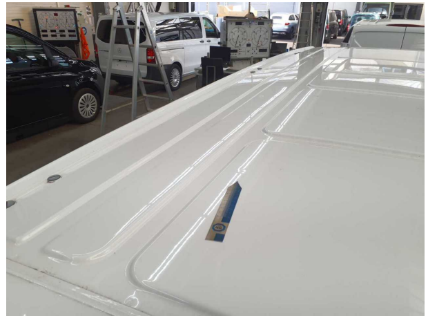
Beschädigung #4: Fahrzeugdach: Dach - Delle(n) - Smart Repair
