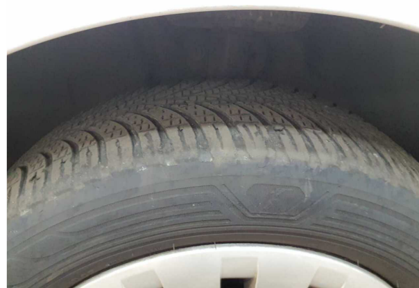
Beschädigung #14: Rad/Reifen: Reifen vorn - verschlissen - erneuern
