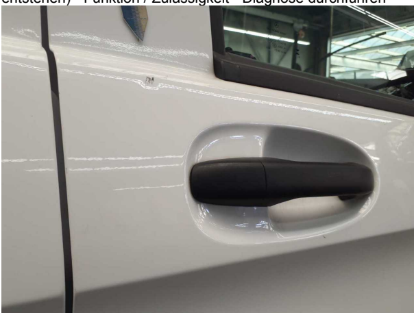
Beschädigung #10: Tür vorn rechts: Tür - Delle / Lackschaden - Smart Repair
