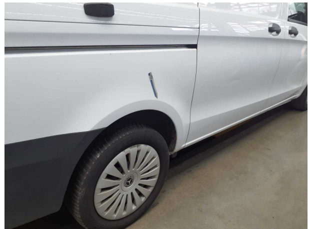
Beschädigung #7: Seitenwand rechts: Seitenwand - Kratzer - Smart Repair
