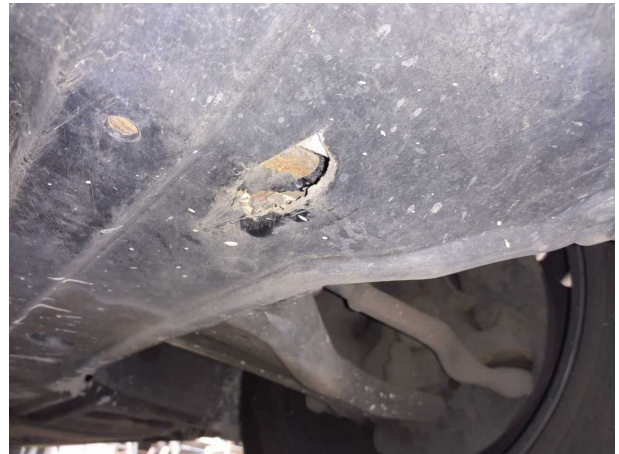
Beschädigung #21: Vorderachse: Achsträger - verformt - erneuern
