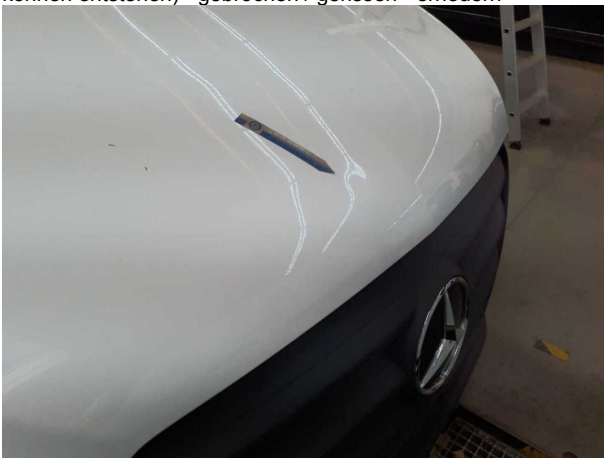
Beschädigung #6: Motorhaube: Motorhaube - Delle(n) - Smart Repair
