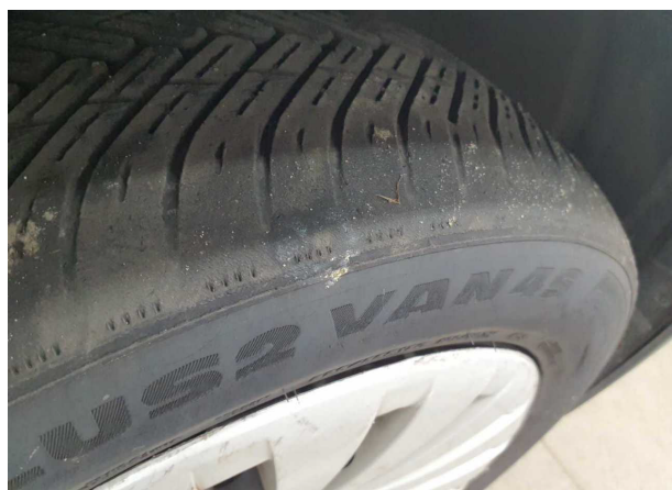
Beschädigung #14: Rad/Reifen: Reifen vorn - verschlissen - erneuern
