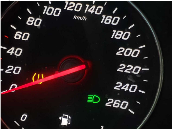
Beschädigung #9: Rad/Reifen: Drucksensor (Mehrkosten können entstehen) - Funktion / Zulässigkeit - Diagnose durchführen
