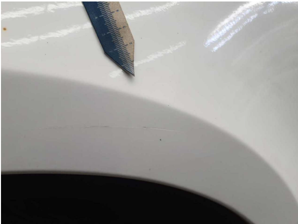
Beschädigung #7: Seitenwand rechts: Seitenwand - Kratzer - Smart Repair
