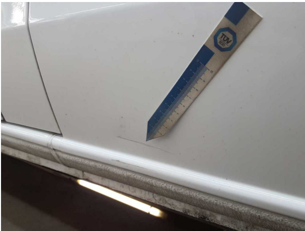
Beschädigung #20: Seitenwand links: Seitenwand - Delle / Lackschaden - instandsetzen und lackieren
