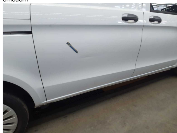
Beschädigung #15: Schiebetür rechts: Schiebetür mit Glasscheibe - Delle / Lackschaden - instandsetzen und lackieren
