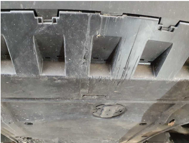
Beschädigung #3: Motor: Motorverkleidung unten vorn (Mehrkosten können entstehen) - gebrochen / gerissen - erneuern
