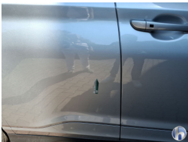
2. Tür Hinten - Rechts Oberflächenkratzer - Auslegen / Polieren
