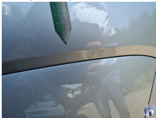
12. Seitenwand - Hinten - Links Oberflächenkratzer - Auslegen / Polieren
