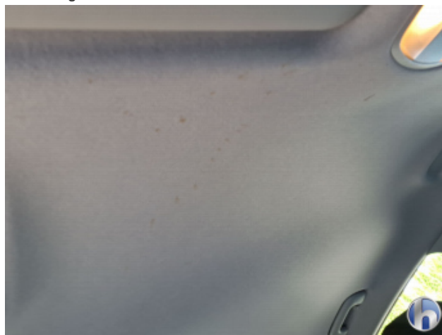
15. Dachhimmel Verschmutzt - Reinigen
