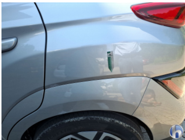
12. Seitenwand - Hinten - Links Oberflächenkratzer - Auslegen / Polieren
