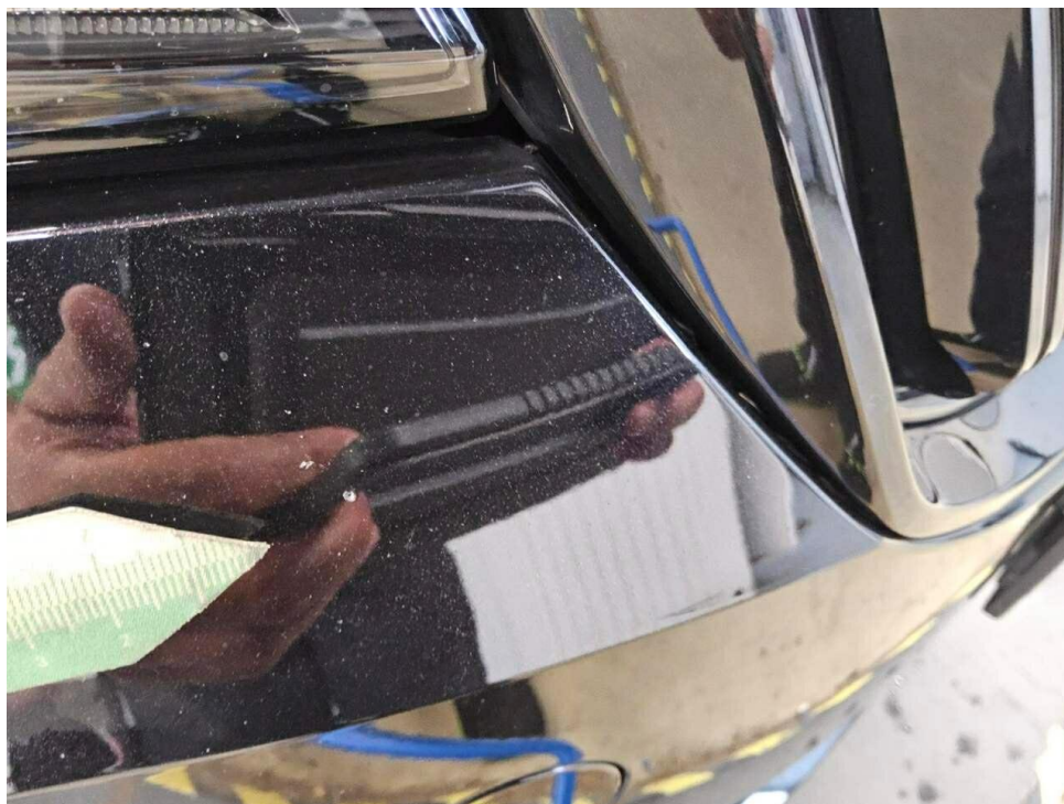
Bild 17 : Stoßfänger vorne Lackierung, Steinschlag, Gebrauchsspur
