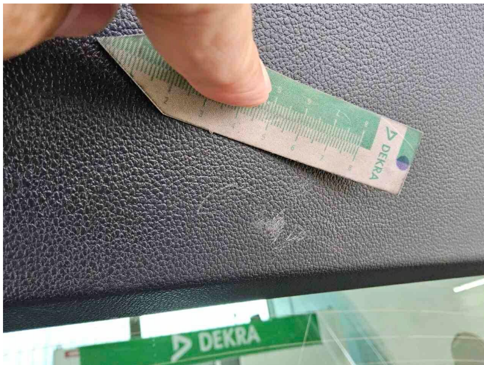
Bild 15 : Verkleidung Heckklappe, zerkratzt, Gebrauchsspur
