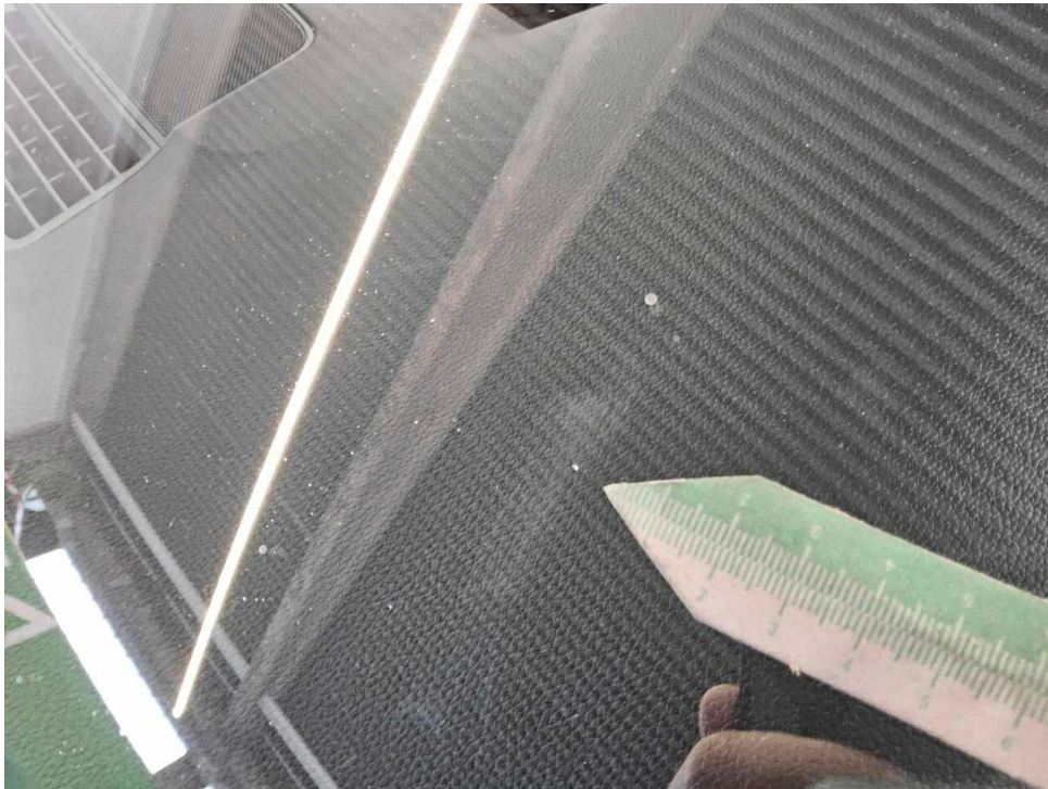
Bild 21 : Frontscheibe, Steinschlag, Gebrauchsspur
