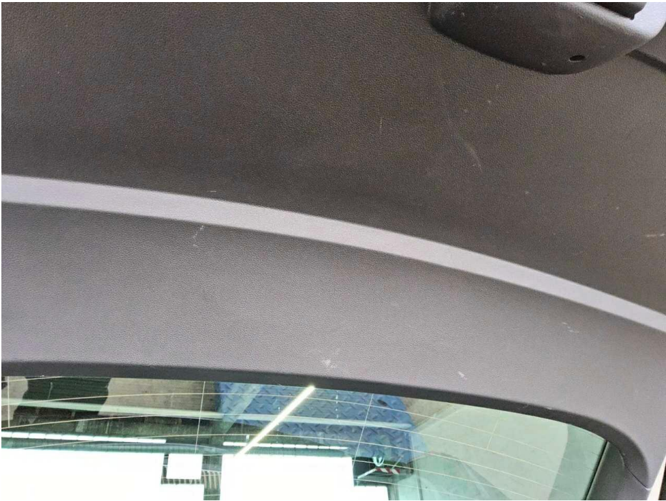
Bild 14 : Verkleidung Heckklappe, zerkratzt, Gebrauchsspur
