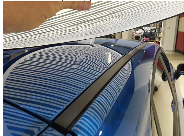
Beschädigung #2: Fahrzeugdach: Dach (2 x Delle links und rechts am Dachholm) - Delle(n) - sanft instandsetzen
