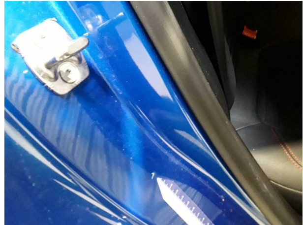
Beschädigung #1: Karosserie: C-Säule rechts unten - Delle / Lackschaden - Smart Repair
